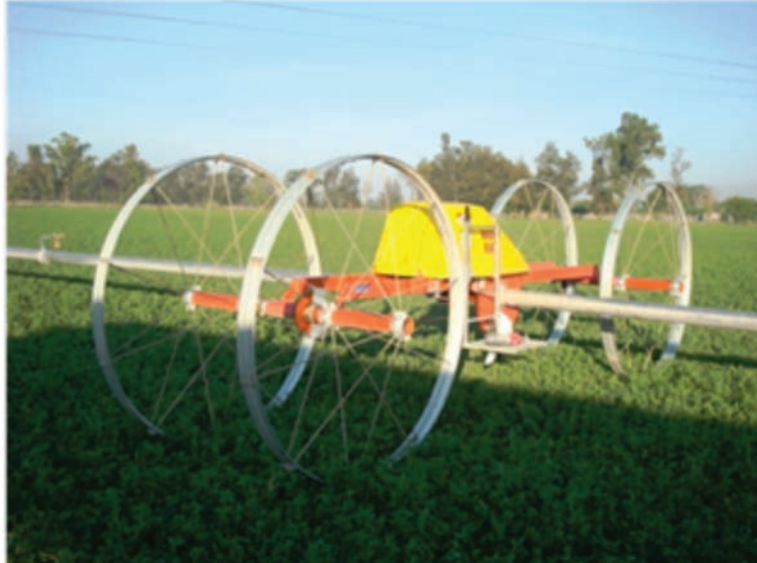
Figura 5.8. Motor y sistema de tracción para generar el avance de la tubería regante, rodando sobre su propio eje.
