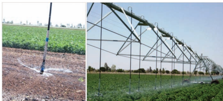
Figura 5.17. Microaspersor y tubería regante de avance frontal.
