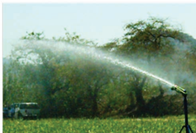
Figura 5.7. Aspersor gigante de un sistema de riego por aspersión portátil manual con su elevador.
