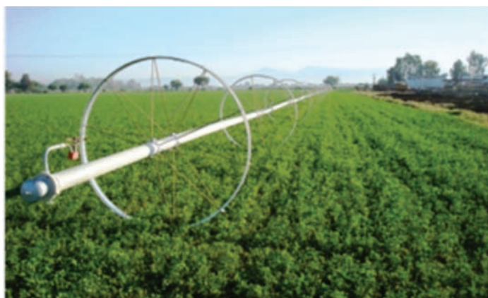
Figura 5.10. Aspersor con contrapeso conectado al final de la tubería rodante en posición correcta de riego.
