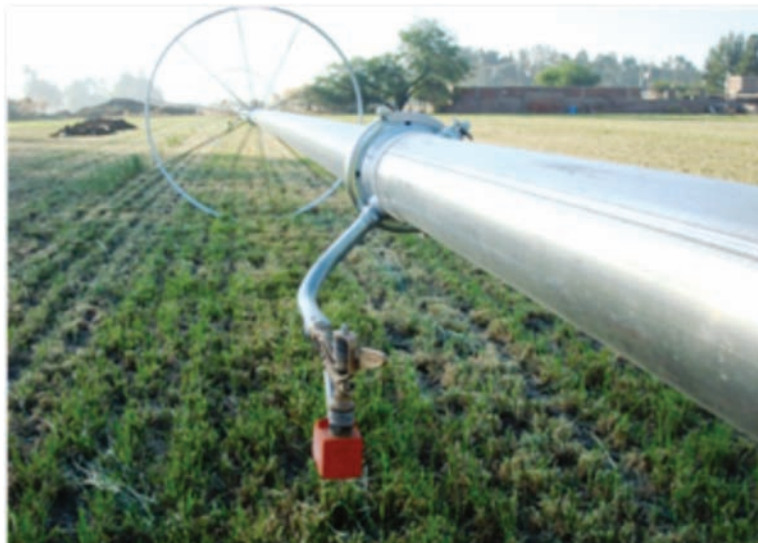
Figura 5.9. Aspersor con contrapeso conectado a la tubería rodante en posición incorrecta de riego.
