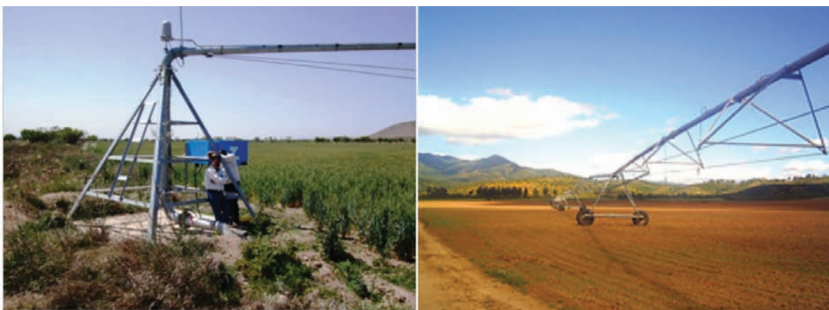
Figura 5.14. Sistemas de riego con pivote central para permitir el giro de la tubería regante.
