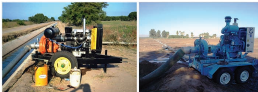
Figura 5.3. Equipos de bombeo de sistemas de riego por aspersión portátil preparado como remolque para transportarse con tractor.
