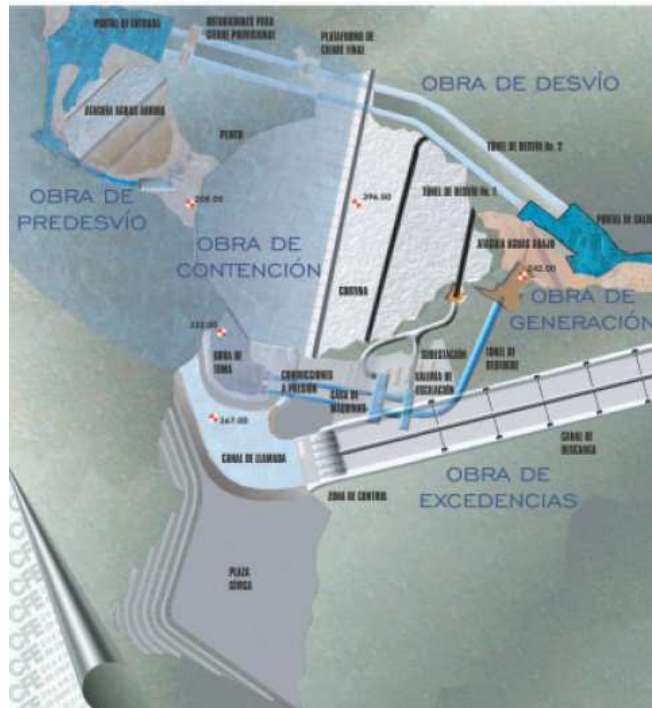
Figura D- 3. Principales componentes de la Central Hidroeléctrica El Cajón
