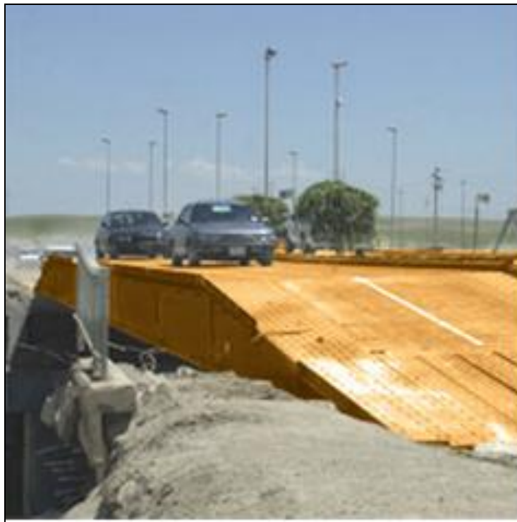
Figura 7.70. Puente de soporte seco. (WFEL, 2012)
