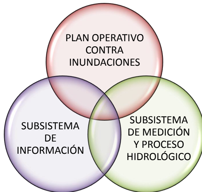
Figura 6.3. Componentes indispensables de un sistema de alerta temprana. (Fuentes, 2002)
