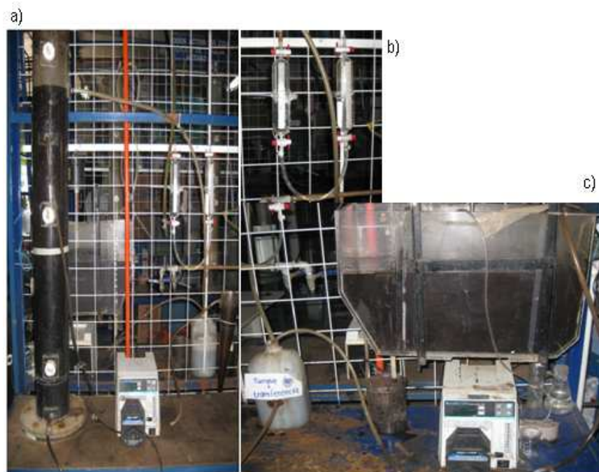
Figura 3.2 Fotografías del sistema experimental. (a) Vista del reactor UASB; (b) medidor de biogás; (c) reactor de lodos activados con aireación intermitente (LAAI).
