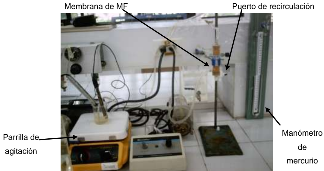
Figura 4.3. Montaje experimental del módulo de MF
