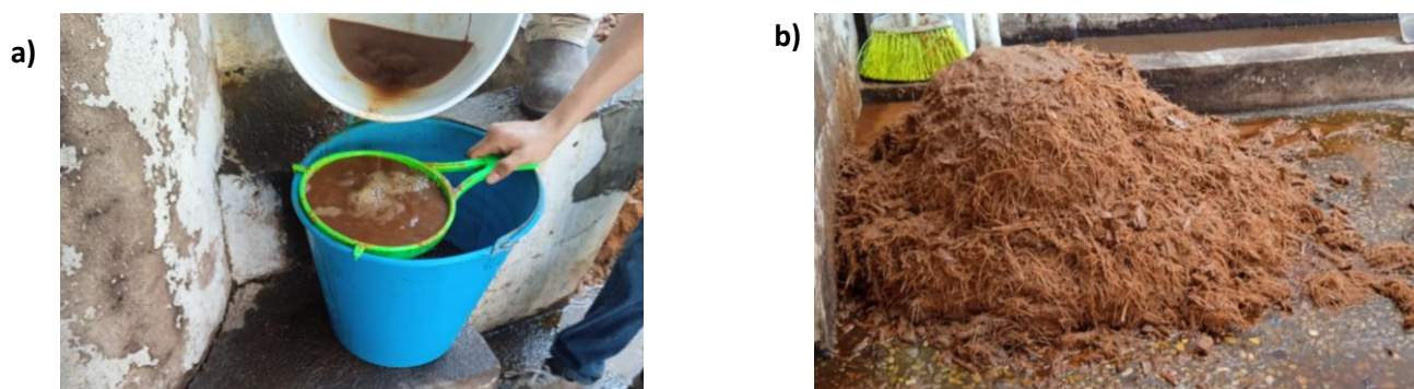
Figura 4.2. Obtención de vinazas: a) Vinaza cruda siendo colada, y b) Sólidos de gran tamaño (como fibra).
