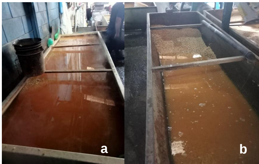
Figura 6. Puntos de muestreo de nejayote dentro del establecimiento (a) cocimiento del maíz a 95 °C y (b) reposo del maíz a temperatura ambiente.
