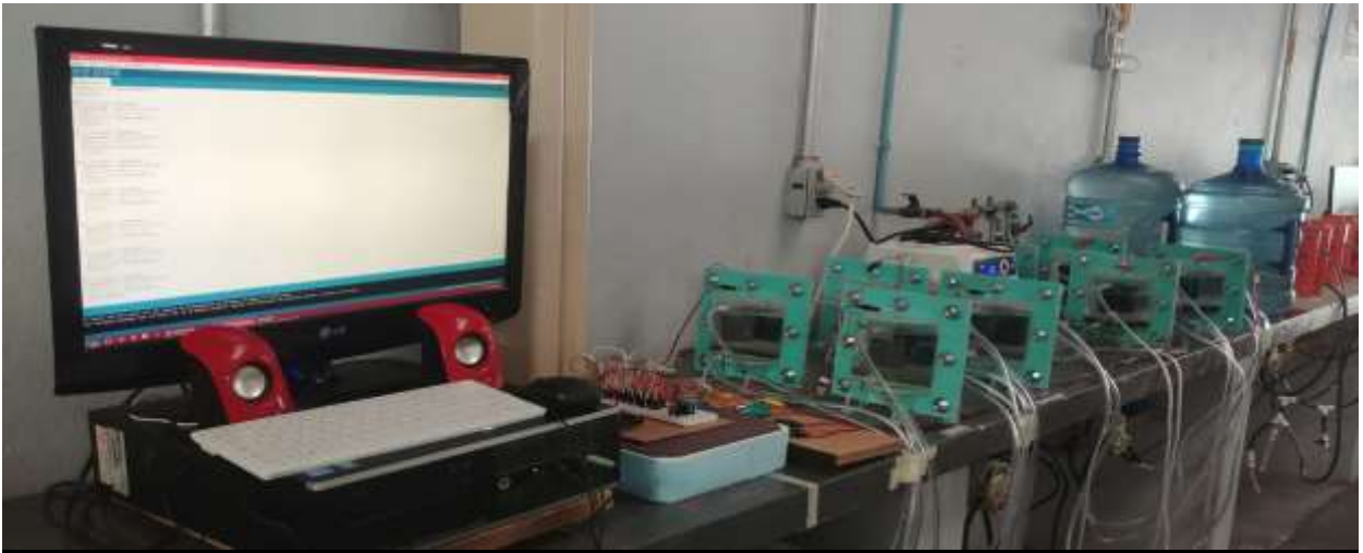
Figura 3.10. Sistema experimental con su sistema eléctrico conectado. A) Conexiones a electrodos; B) Conexiones eléctricas a Arduino Mega 2560; C) Sistema experimental conectado a PC para recabar, procesar y almacenar los datos de voltaje generados.
