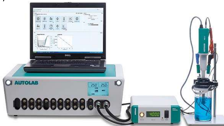
Figura 2.13. Componentes básicos para una prueba electroquímica: (a) estación de trabajo electroquímica Autolab, modelo Metrohima; (b) celda electroquímica de vidrio de tres electrodos (ER, ET, EA) con controlador de temperatura por flujo de agua conectando al espacio para baño termostático.
