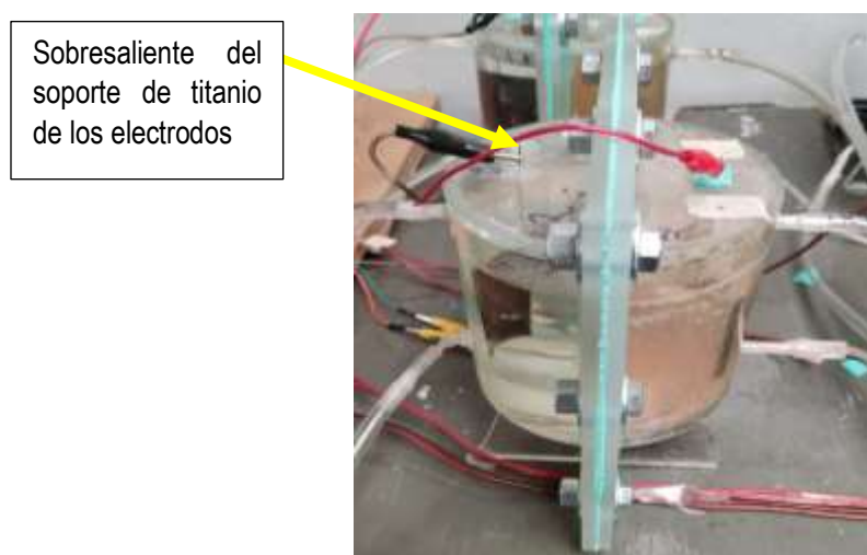
Figura 3.9. CCM de trabajo donde se visualizan las conexiones eléctricas de los electrodos.
