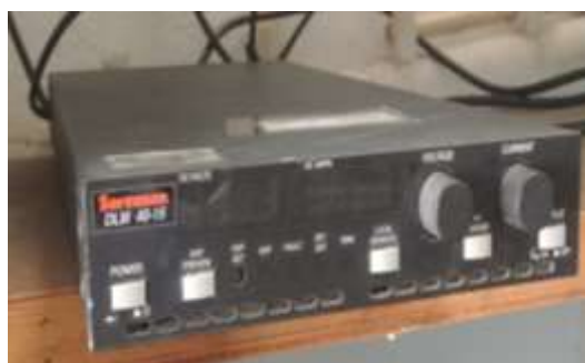
Figura 3.6. Electrodeposición en electrodo anódico: A) Fuente de poder con regulador de amperaje; B) Vaso de precipitado con solución de cloruro de manganeso.
