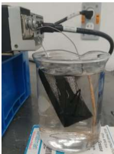
Figura 3.6. Electrodeposición en electrodo anódico: A) Fuente de poder con regulador de amperaje; B) Vaso de precipitado con solución de cloruro de manganeso.
