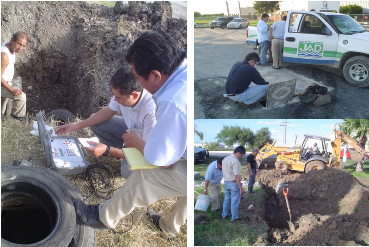
Ilustración 9.5. Medición de caudal en campo empleando equipos ultrasónicos (Punto de muestreo #7)
