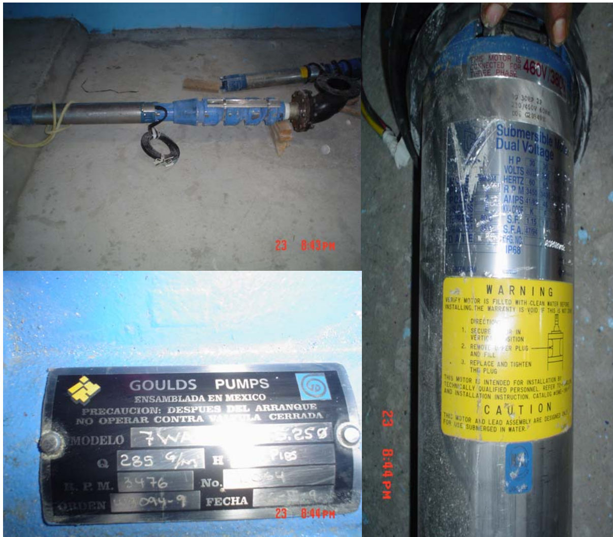
Ilustración 4.15. Bomba marca Goulds con tres pasos, Q = 285 GPM, R.P.M. = 3476 y H = 282 ft.
