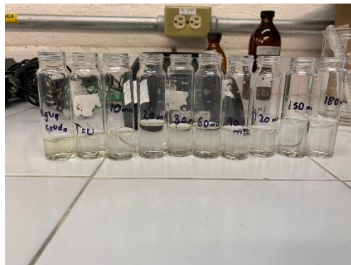
Ilustración 13 Comparación del color del agua cruda de pozo después de primer tratamiento electroquímico
