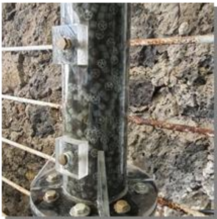
Ilustración 2 Anillos kaldness K1 empacados en el biofiltro (fuente propia)
