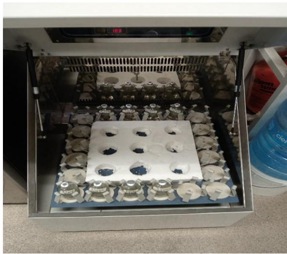
Ilustración 30. Incubadora para mantener los cultivos en lote a temperatura y agitación constantes.
