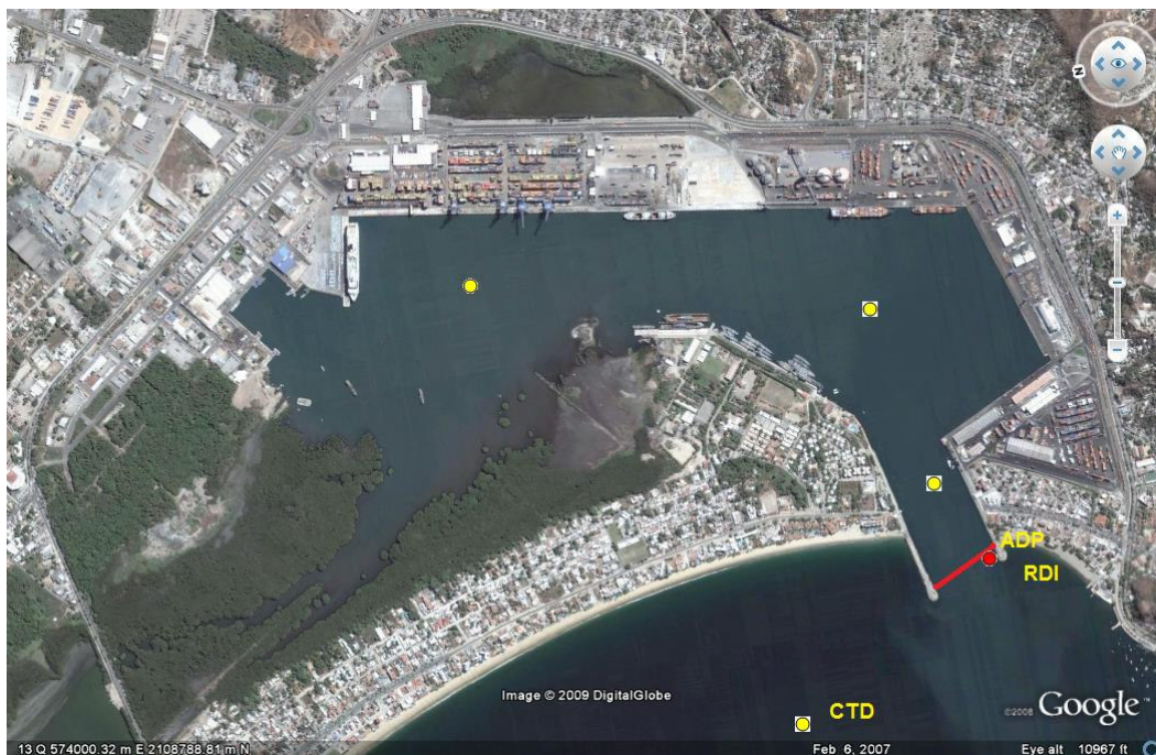
Figura 3.1 Esquema de mediciones de CTD, el anclaje y las secciones principales con el ADCP.
