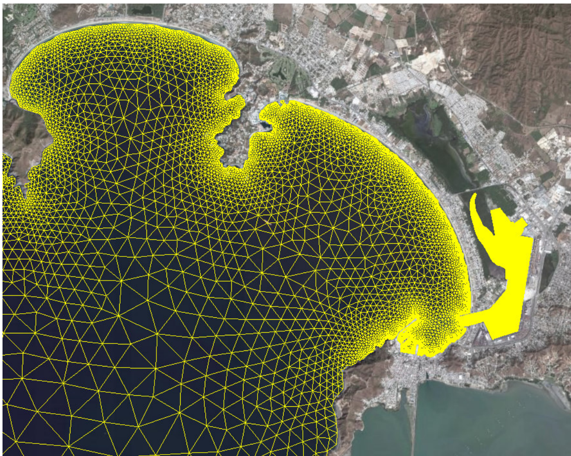
Figura 5.2 Detalle de la malla de las bahías.
