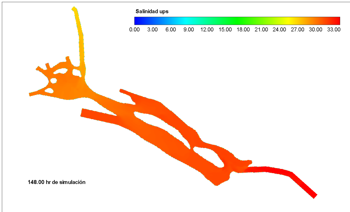
Figura 6.4 Concentración de salinidad a 148.0 h de simulación, escenario1.
