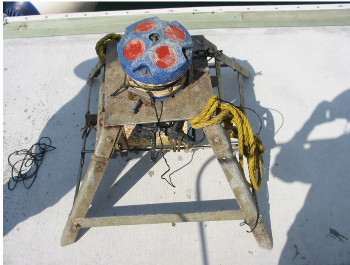
Figura 3.12 Medidor ADCP marca RD&Instruments de 600 kHz.
