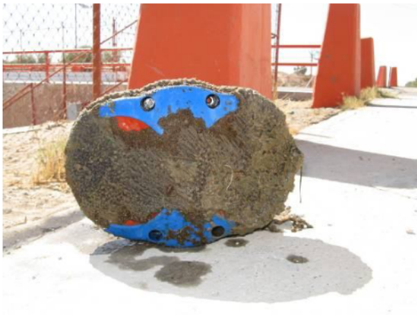
Medidor retirado del agua
