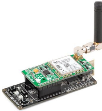
Figura 3.15 Conexión con modem GSM/GPRS
