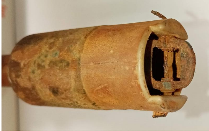
Figura 3.65. Sensor de flujo medidor SDI pozo no. 22
