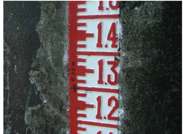
Posición de referencia para el sensor de nivel (+ 6.29 m)
