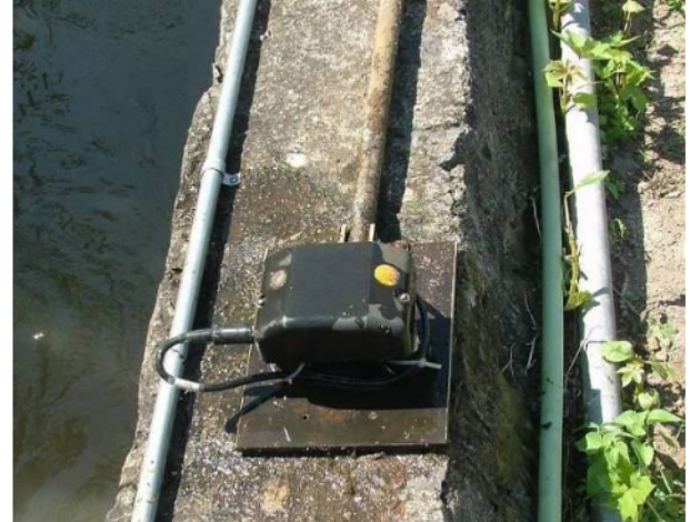
Segundo aforador tipo ADL (modelo "Argonaut-SL", marca "Sontek")
