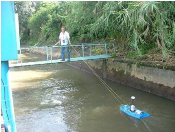
Calibración del aforador ADL en el km 0+130
