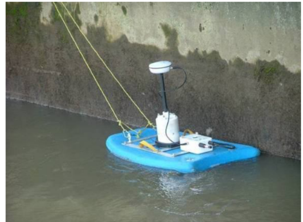
Perfilador Doppler (modelo "M9", marca "Sontek") usado para calibrar
