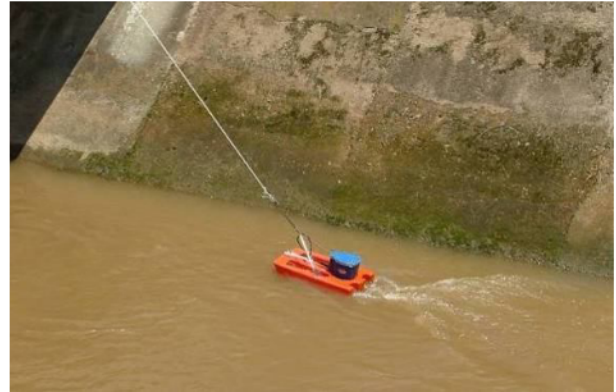
Otro equipo PD probado: modelo "StreamPro" (marca "Teledyne / RDI")
