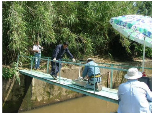
Primer aforador tipo ADL (modelo "ChannelMaster", marca "RDI")
