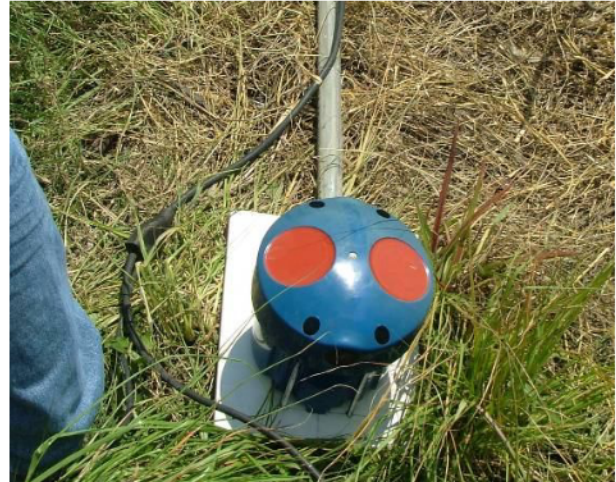
Primer aforador tipo ADL (modelo "ChannelMaster", marca "RDI")
