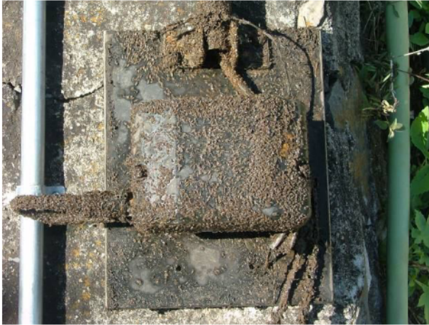
Segundo aforador tipo ADL cubierto de lama y de pequeños crustáceos
