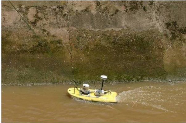
Equipo PD tomado como referencia: modelo "M9" (marca "Sontek / Ysi")
