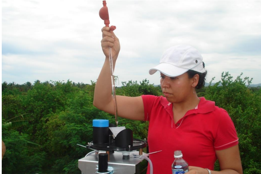
Figura 99 Calibración del pluviómetro
