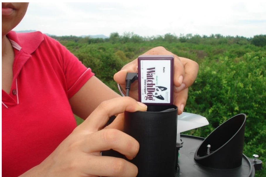
Figura 100 Instalación de la memoria del pluviómetro
