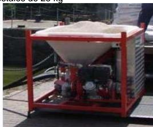
Preparación de la suspensión de Phoslock
