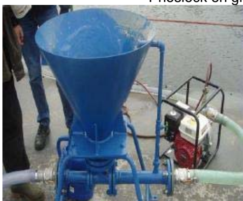
Preparación de la suspensión de Phoslock
