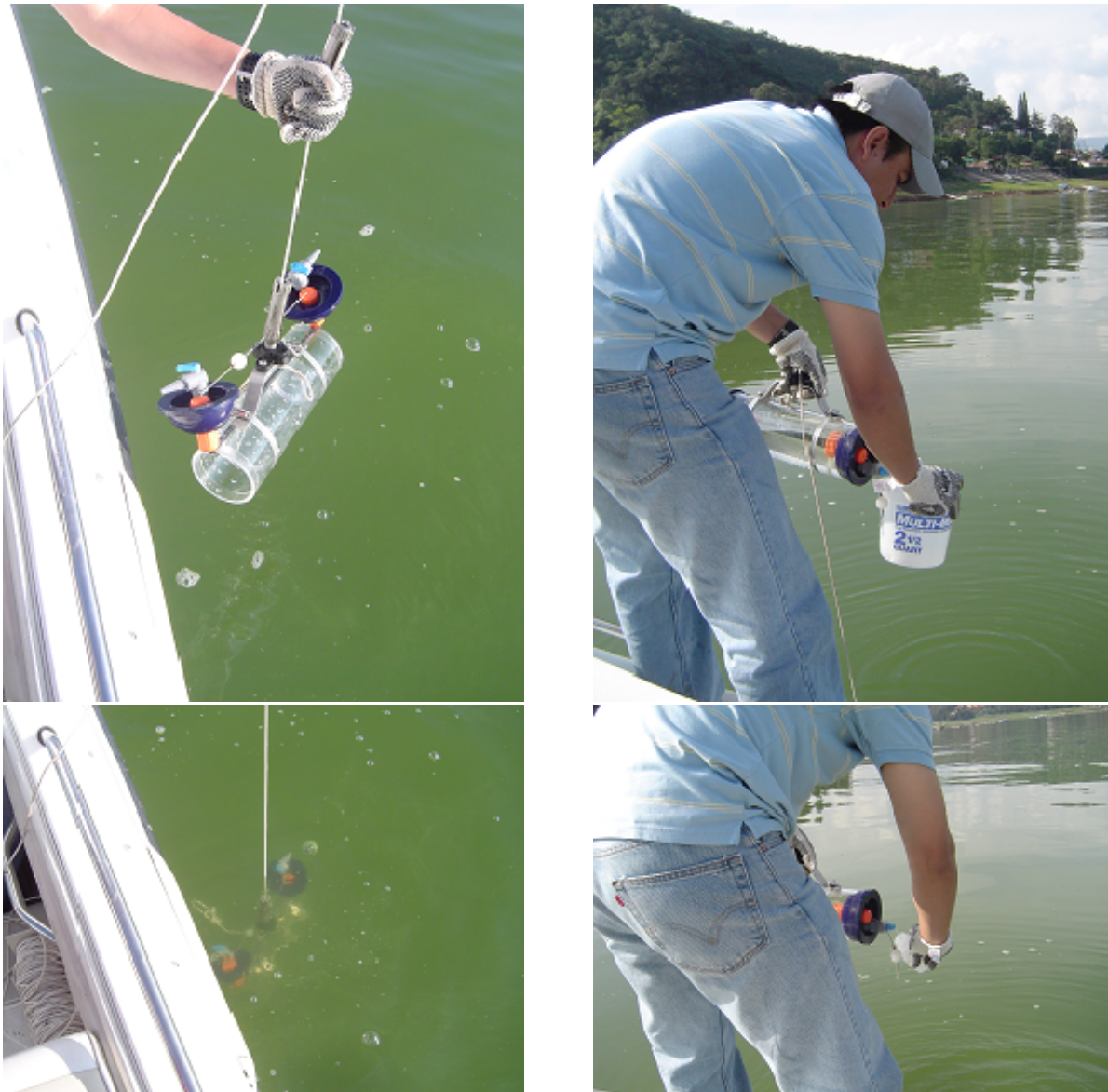
Figura 3. Muestreo de agua con botella van Dorn
