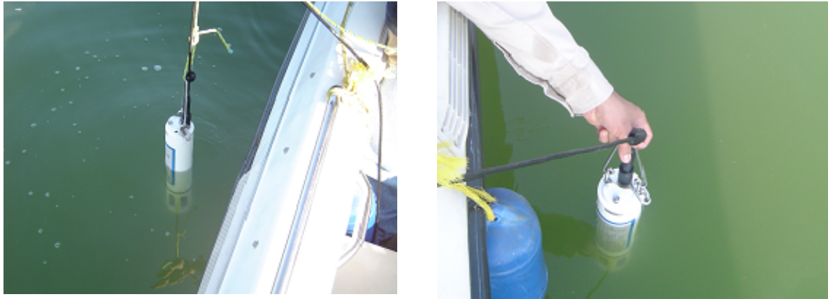
Figura 4. Medición de parámetros en agua con equipo Hydrolab (Hach DS5)
