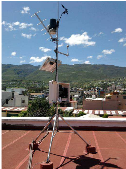
Figura 13.38 Estación DAVIS con transmisión satelital instalada en las instalaciones de Protección Civil en Chilpancingo, Gro.
