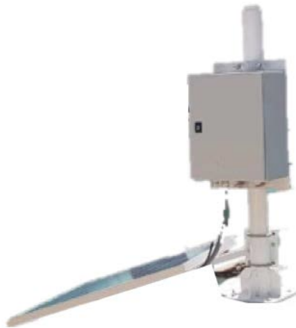
Figura 10.40 Fotografía donde se muestra el gabinete y del panel fotovoltaico que integran propuesta de la estación de medición.
