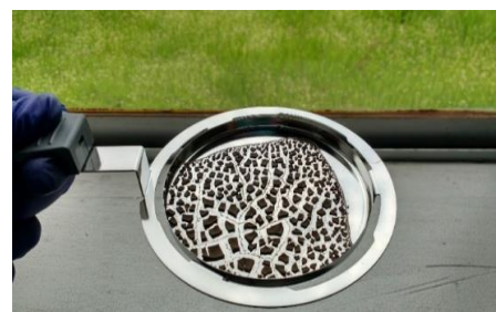
Figura 4. Deshidratación de lodo a un pH 7 en un tiempo de 77 min.
