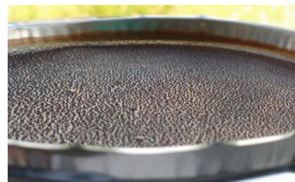
Figura 3. Deshidratación del lodo inicial en un tiempo de 78 min.
