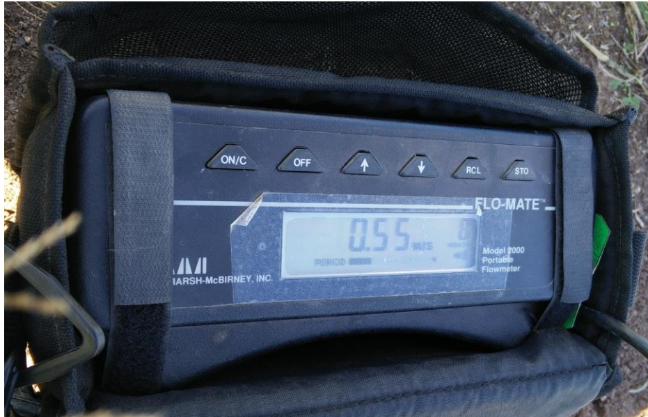
Figura 2. Caratula de molinete automatizado, ultrasónico o magnético.
