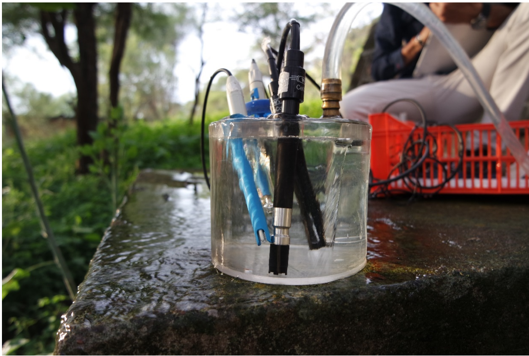
Figura 7.4 Medición de parámetros de campo con electrodos y equipos multiparamétricos, celda de aislamiento
