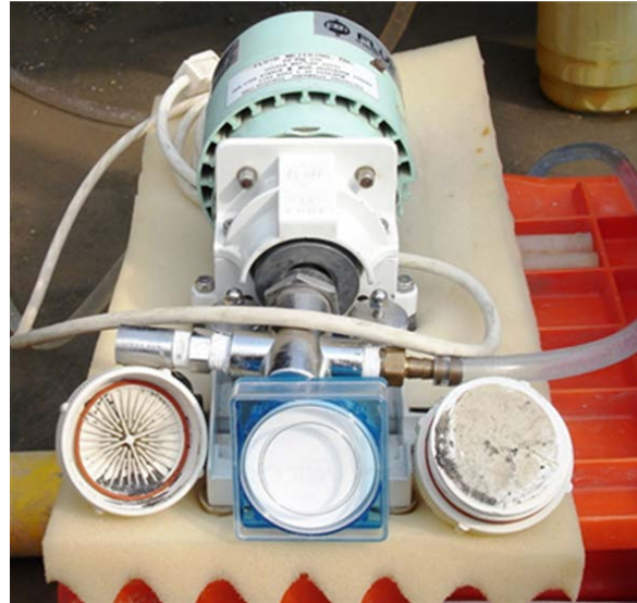
Figura 7.2 Filtrado de muestras de agua con membrana de celulosa de 0.45\mu a presión positiva
