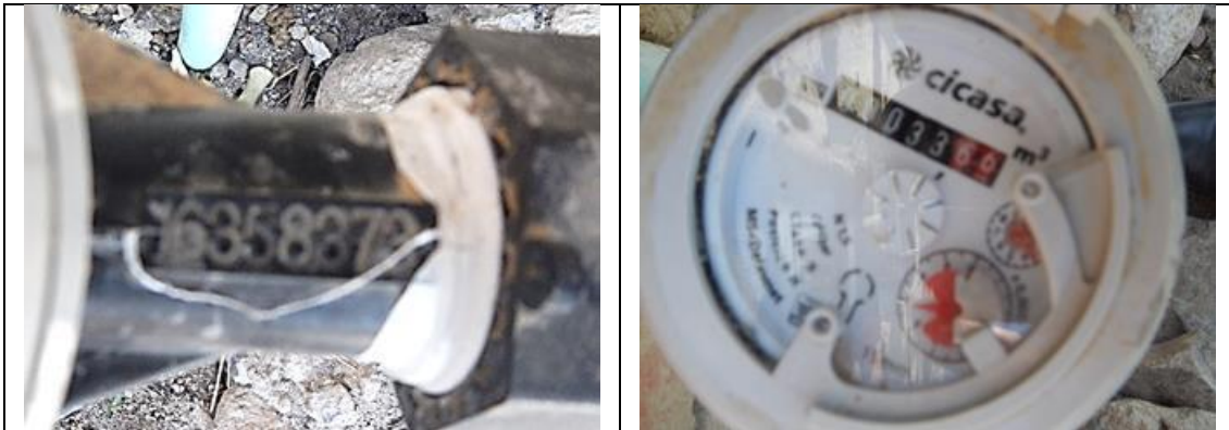
Figura 8. Medidor CICASA, MS Delaunet 16358373, clase B, sin VAF. Detalles de medidor con número de serie. Comunidad La Purísima de la Cueva, municipio de Corregidora. Lectura del medidor: 33.66 m 3 . Se encontró que debe corregirse la marca (es Cicasa, no Itrón) y el modelo (es MS-Delaunet, no Multimag), en el padrón de usuarios. Atendió usuario.
