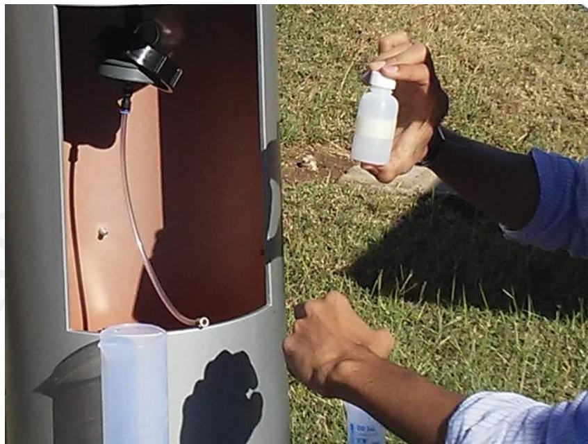
Figura 120 Enjuague de botellas de polietileno de alta densidad con muestra obtenida.
