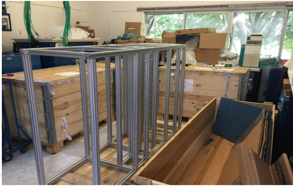
Figura 35 Soporte estructural armado, preparado para ensamblar los dispositivos de desplazamiento
