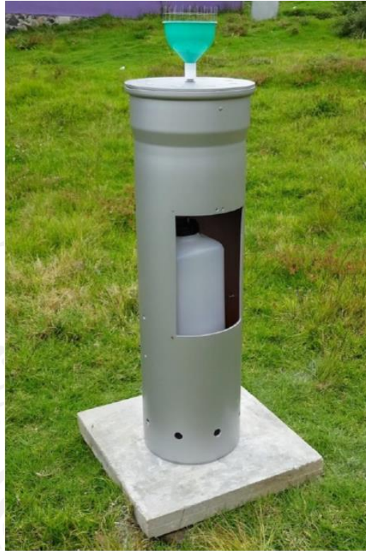
Figura 51 Colector totalizador de la precipitación pluvial, Mod. RS2 PALMEX
