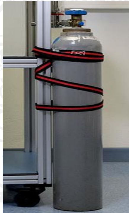
Figura 13 Cilindro de CO 2 , 200 Litros de capacidad a 50 bar de presión, utilizada en el proceso de neutralización de alcalinidad.
