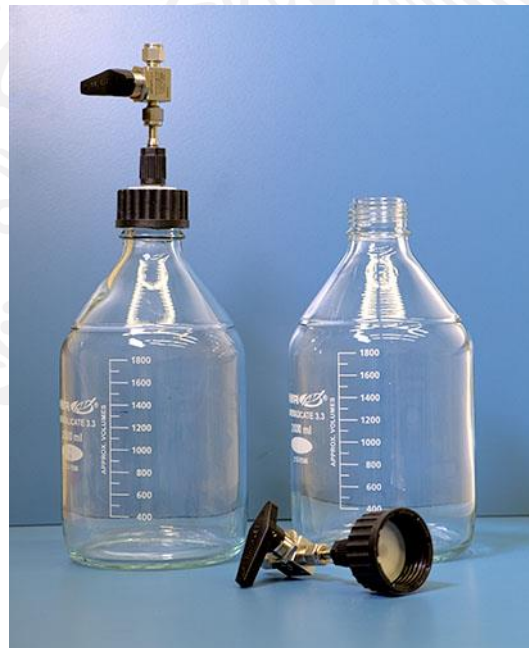
Figura 5 Ámpulas de alimentación continua con capacidad de 2 litros, con válvula variable según la necesidad de tener un bajo o alto Factor de enriquecimiento.
