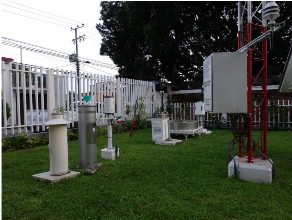
Figura 144 Colector y pluviómetro instalados en el observatorio meteorológico de la CONAGUA, Cuernavaca, Morelos
