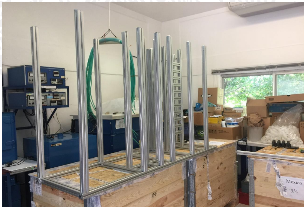
Figura 34 Estructura central y lateral del rack
