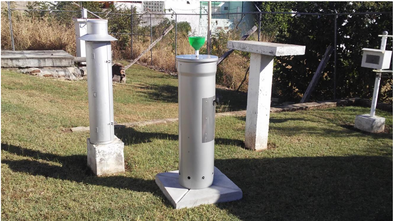
Figura 103 Colector de lluvia en el Observatorio de Tuxtla Gutiérrez.
