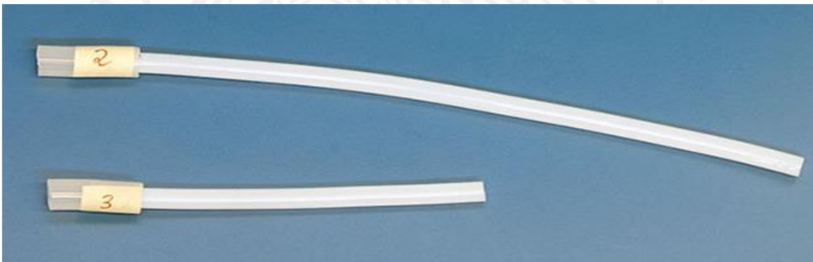
Figura 15 Tubos de teflón, utilizados para conectar las celdas a los tubos de vidrio correspondientes durante la destilación final.
