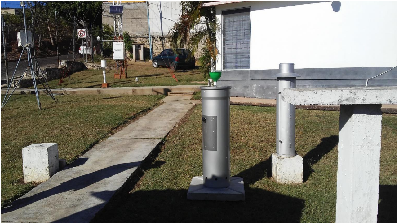
Figura 102 Colector de lluvia en el Observatorio de Tuxtla Gutiérrez.
