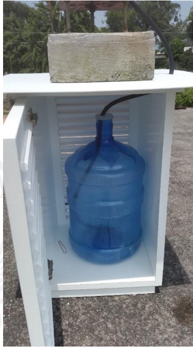
Figura 165 Se limpio parte donde se guarda el cilindro colector de pluviómetros
