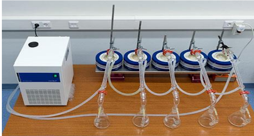
Figura 22 Unidad estándar de pre-distilación, integrada por un generador de refrigeración y conjuntos de unidades de destilación (calentadores, frascos, juntas de vidrio, etc.).
