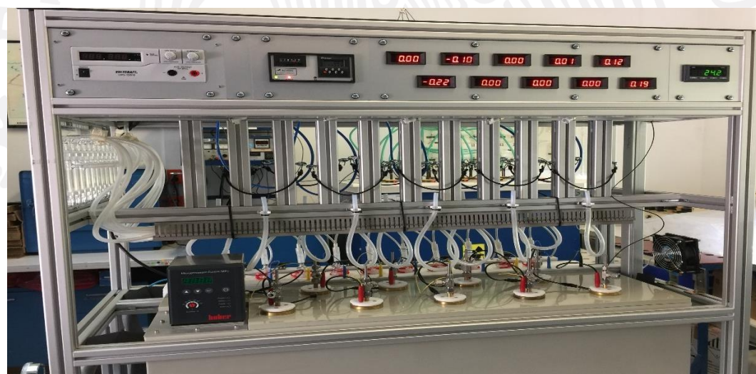
Figura 43 Prueba de instrumentos de control e indicadores electrónicos de la TEU
