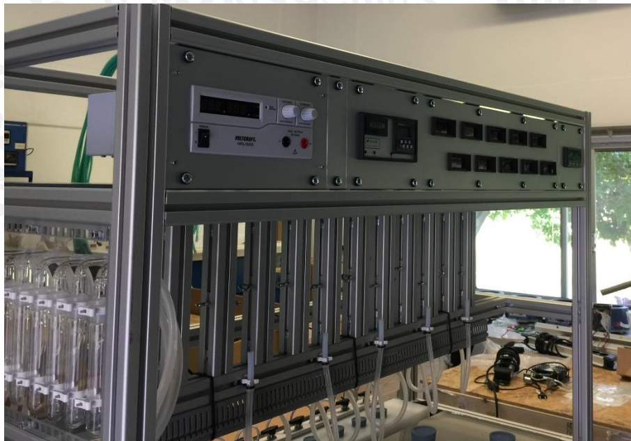
Figura 40 Integración de instrumentos de control (fuente de poder, contador de Ampere/hora, controlador de temperatura, indicadores de voltaje de cada celda)
