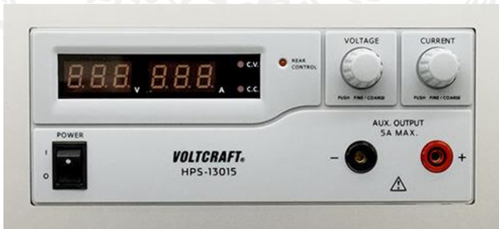
Figura 9 Fuente de alimentación CD, utilizada para subministrar la corriente a las celdas electrolíticas.
