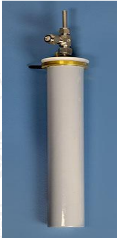
Figura 2 Celdas electrolíticas, cada una con capacidad de almacenar máximo 250 mililitros de muestra de agua.
