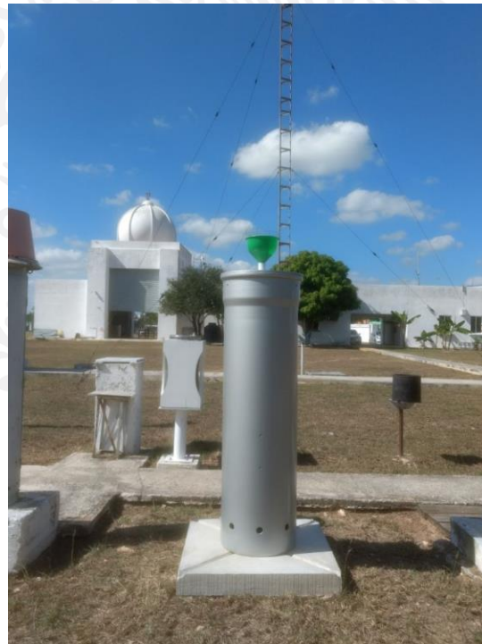
Figura 88 Colector de lluvia en el Observatorio de Mérida.
