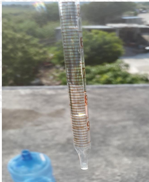
Figura 163 Pipeta graduada utilizada para la calibración de balancines
