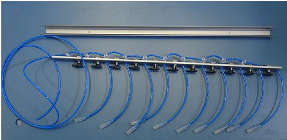
Figura 18 Líneas de vacío, usadas en el proceso de destilación final.
