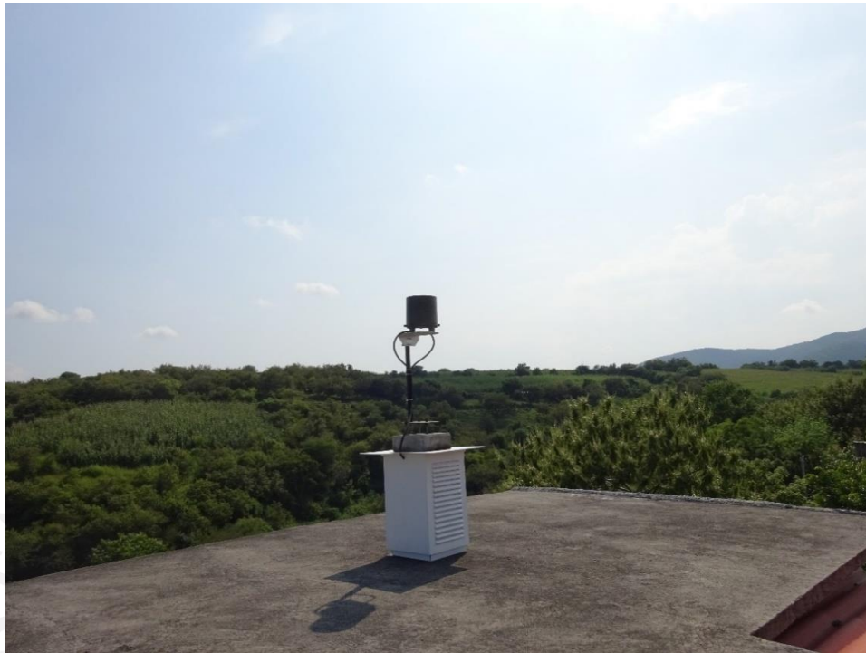
Figura 148 Pluviómetro instalado en Tetlama, Morelos
