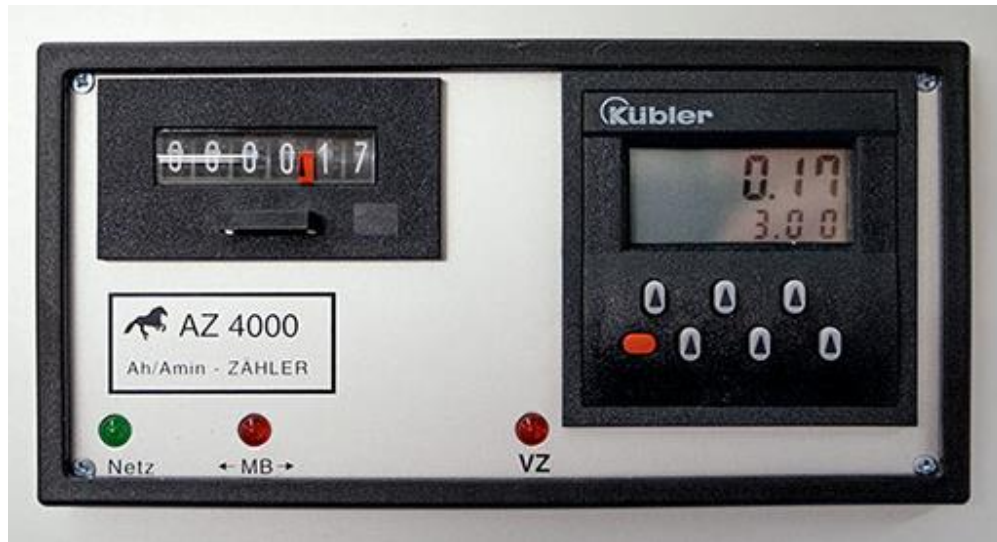
Figura 10 Contador Ah (Ampere-hora) digital, se utiliza para registrar la corriente durante la electrólisis y preestablecer un valor deseado para finalmente detener la electrólisis automáticamente.
