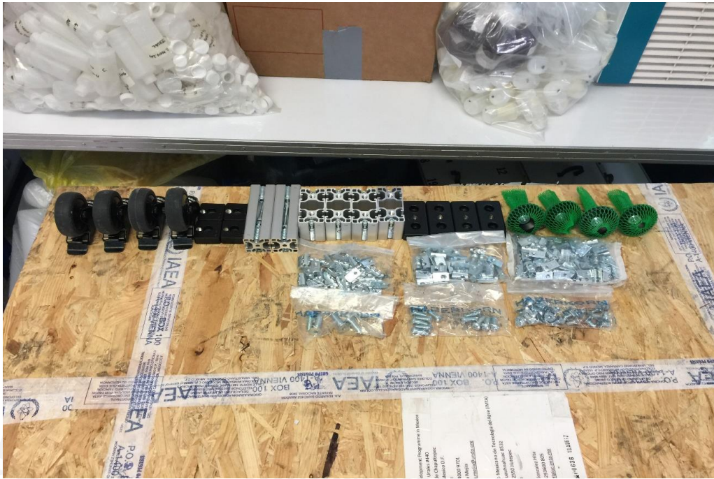
Figura 31 Piezas de desplazamiento y unión para el soporte estructural RACK
