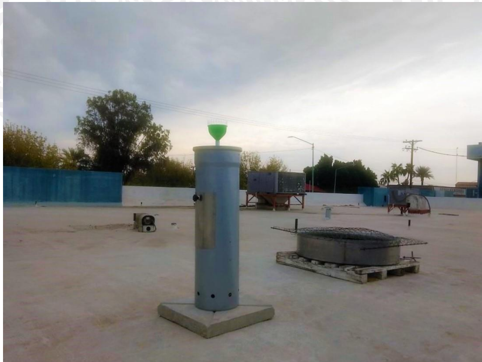
Figura 61 Colector de lluvia en el OCPBC, Mexicali.
