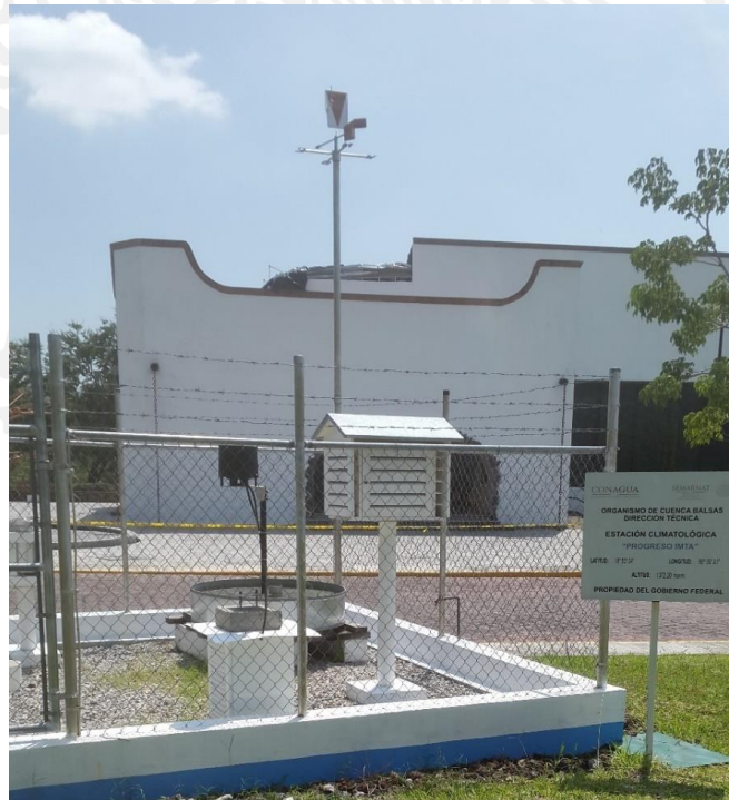
Figura 149 Pluviómetro instalado en el IMTA, Jiutepec, Morelos
