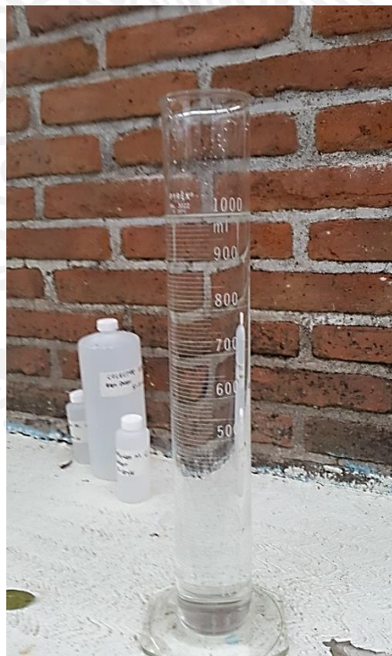
Figura 154 Probeta de 1000 mL utilizada en la medición de la muestra recolectada
