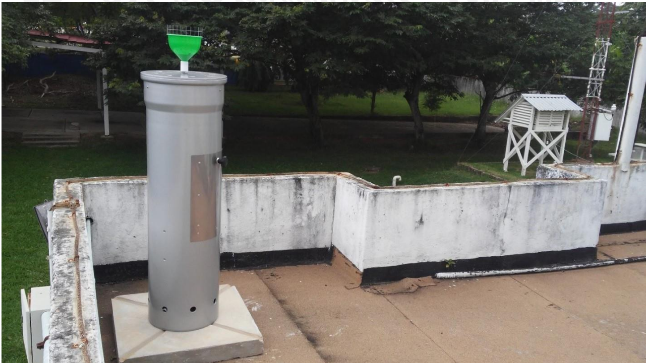
Figura 99 Colector de lluvia en el Observatorio de Villahermosa.
