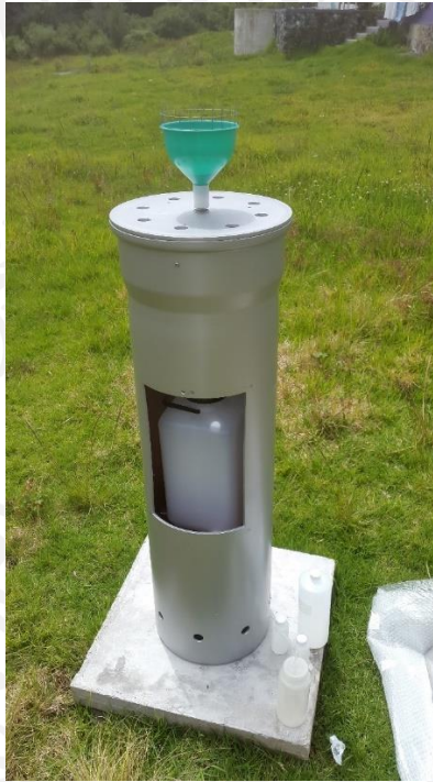
Figura 164 Se limpió parte externa e interna de colectores
