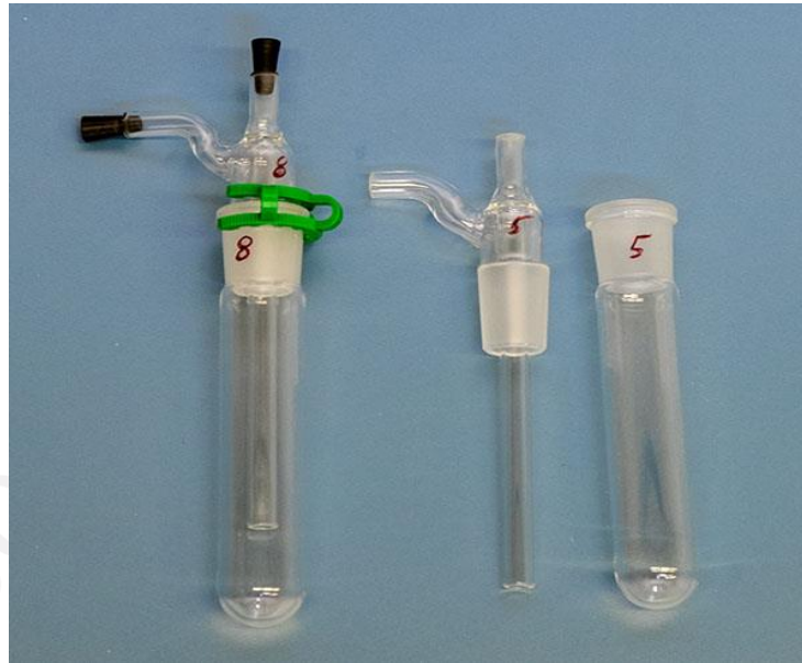
Figura 16 Tubos de vidrio, recogen la muestra de agua enriquecida condensada de cada celda durante la destilación final.
