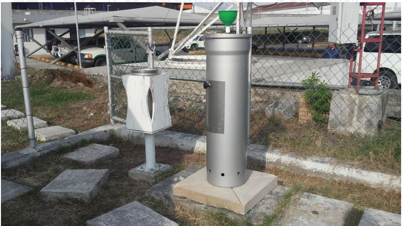
Figura 77 Colector de lluvia en el Observatorio de Monterrey.
