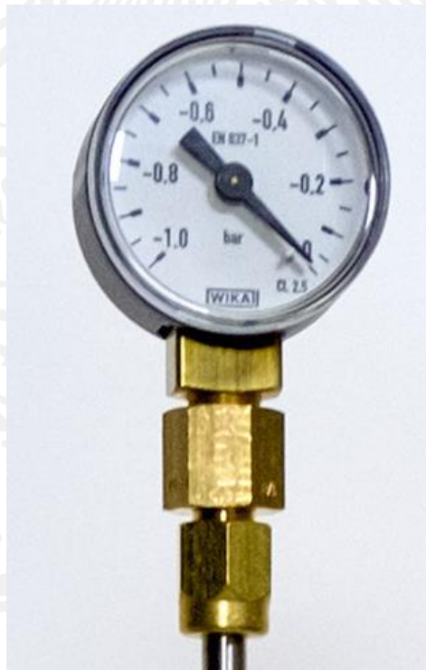
Figura 19 Calibradores de vacío, se fijan a cada celda para medir el nivel de vacío durante el proceso de destilación final
