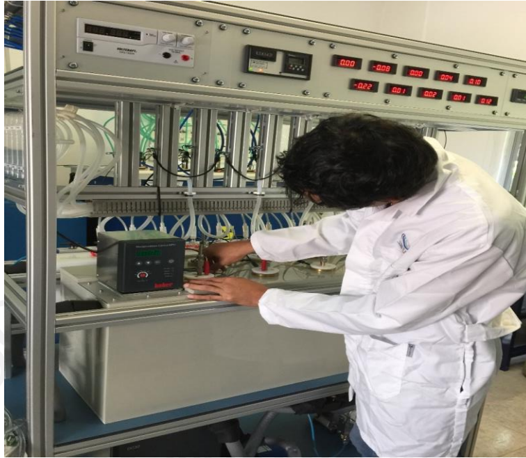
Figura 46 Colocación de cables a cada una de las celdas electrolíticas
