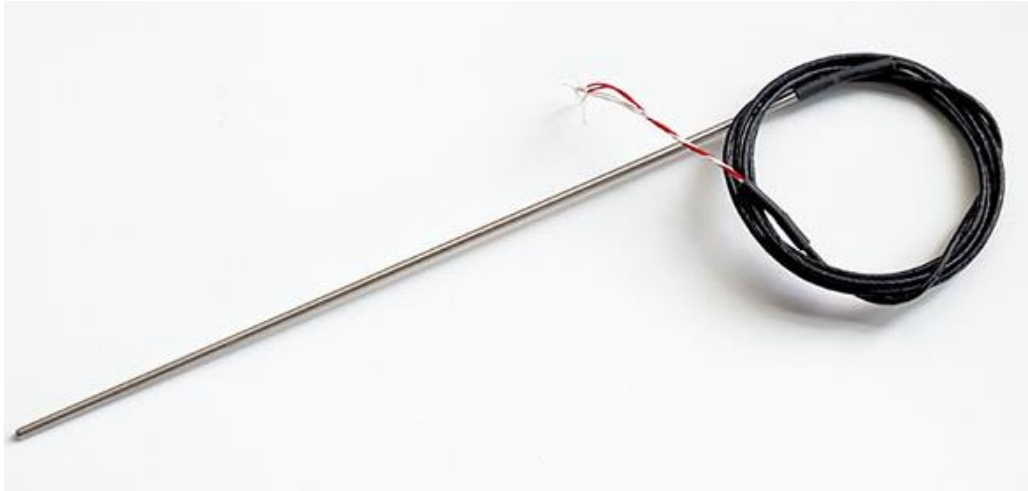
Figura 20 Sensor de temperatura, utilizado para medir la temperatura de los baños de refrigerante grande y pequeño durante diferentes procesos, por medio de un controlador de temperatura digital.
