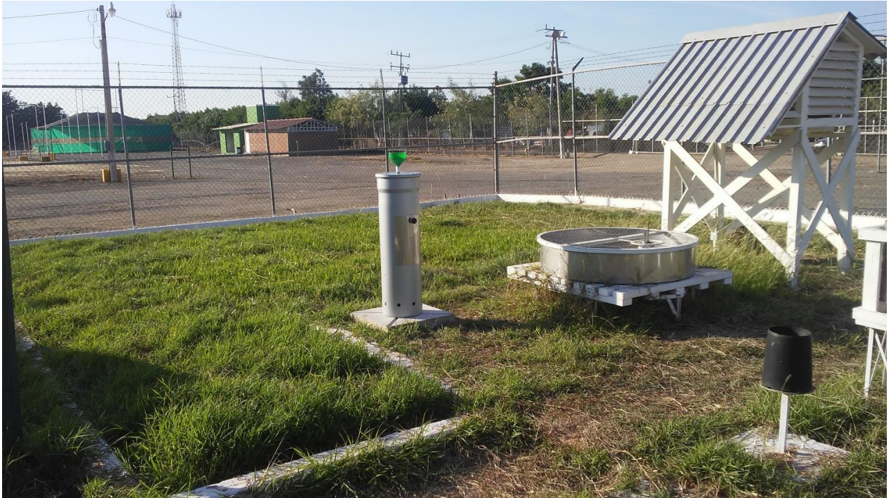
Figura 72 Colector de lluvia en el Observatorio de Culiacán.
