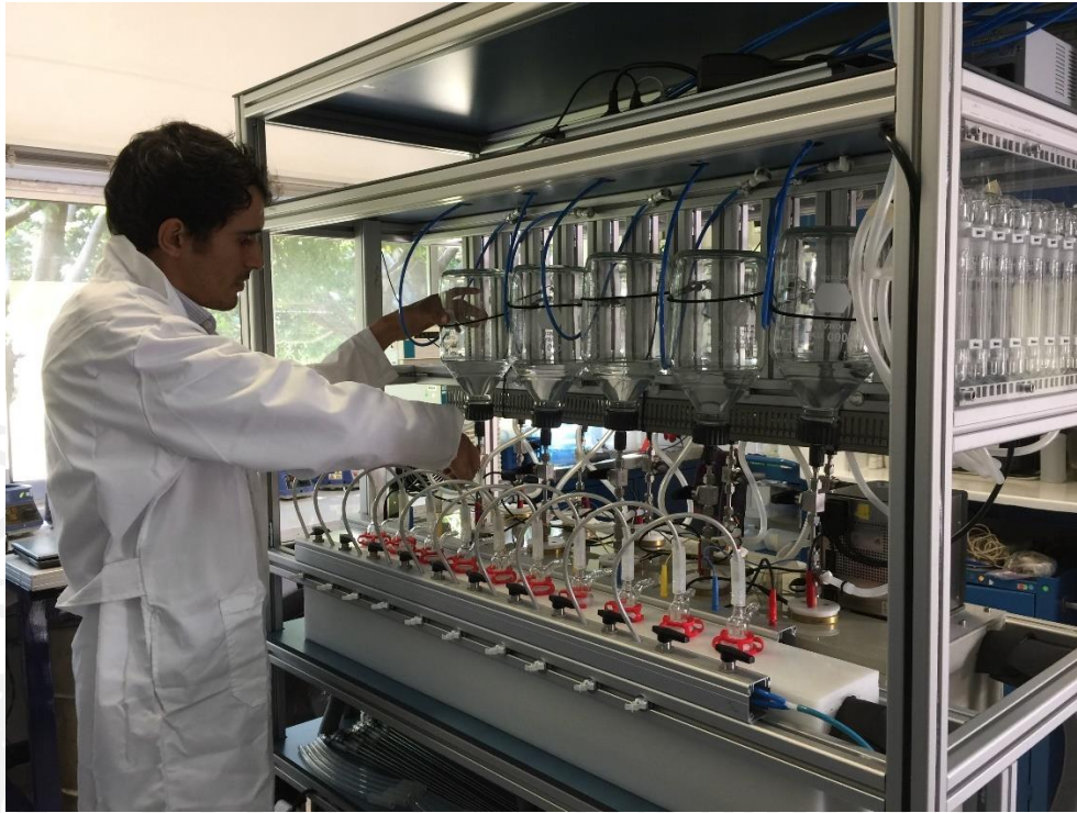
Figura 49 Colocación de tubos destilación final conectados al baño de agua pequeño
