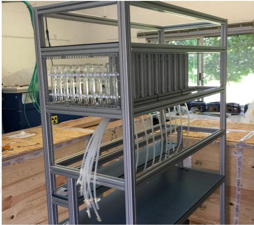
Figura 37 Colocación de los burbujeadores
