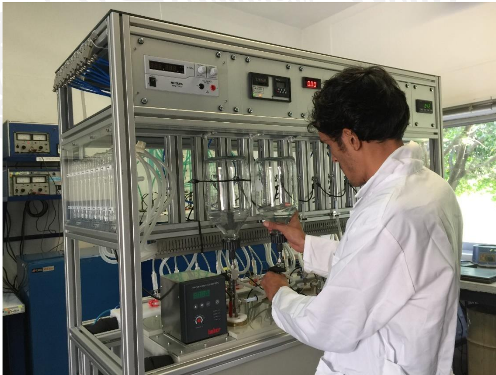
Figura 47 Colocación de las ámpulas de vidrio con capacidad de 2 litros, con 250 ml de la muestra de agua.
