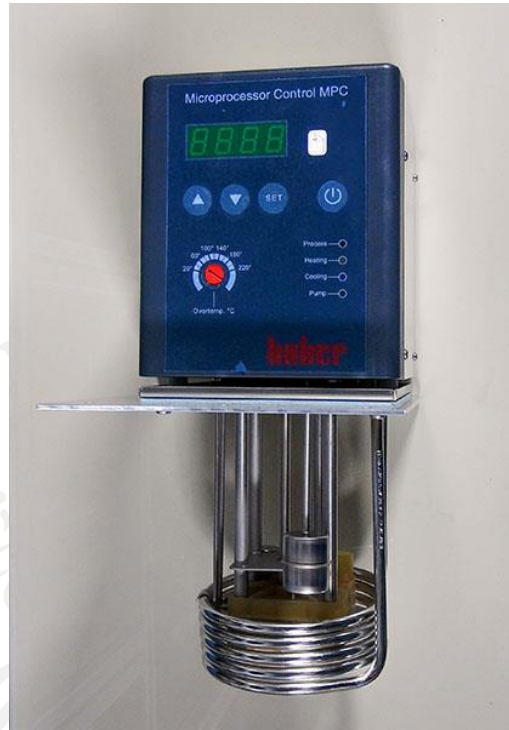
Figura 4 Controlador térmico utilizado en los procesos de electrólisis, neutralización de alcalinidad y destilación final/post.
