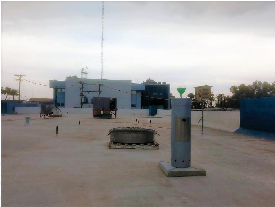
Figura 60 Colector de lluvia en el OCPBC, Mexicali.
