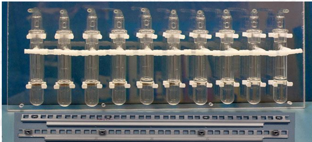
Figura 7 Burbujeadores, cada uno va conectado a una celda electrolítica a través de tubos de silicón para permitir el escape de los gases generados durante el proceso de electrólisis.
