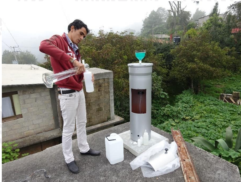
Figura 152 Vertido de muestra a botella de polietileno para análisis de tritio ambiental
