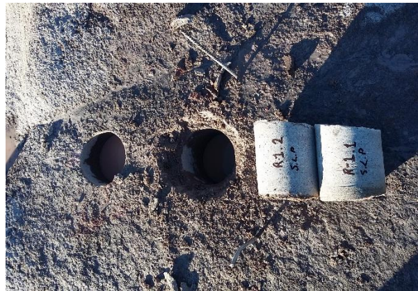
Fotografía III.23 Muestra recuperada R-1
