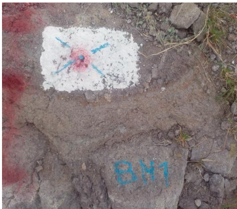
Fotografía III.2 Banco de Nivel BN1 en el extremo izquierdo de la presa San Juan de Coyotillos.
