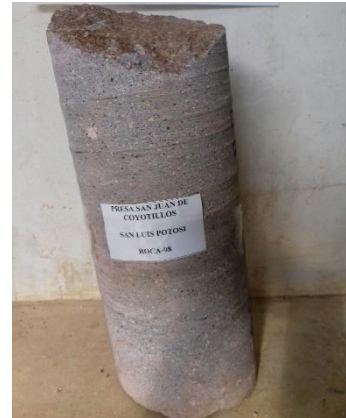
Fotografía III.33 Nucleo de la roca de cimentación para ensaye a compresión uniaxial.
