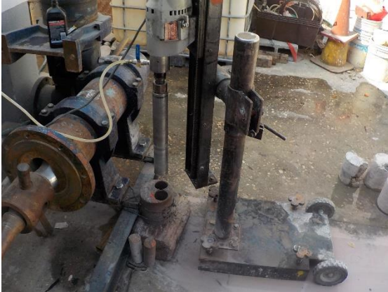
Fotografía III.38 Extracción de muestras del núcleo de la cortina para el ensaye a corte directo.
