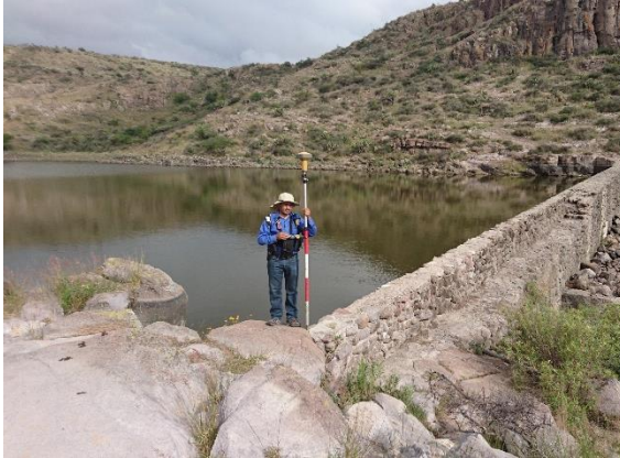
Fotografía III.4 Levantamiento topográfico de la cortina de la presa San Juan de Coyotillos.
