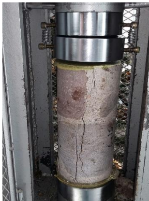
Fotografía III.36 Nucleo ensayado a compresión uniaxial.
