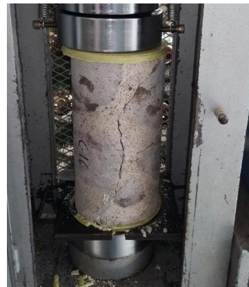
Fotografía III.37 Nucleo ensayado a compresión uniaxial.
