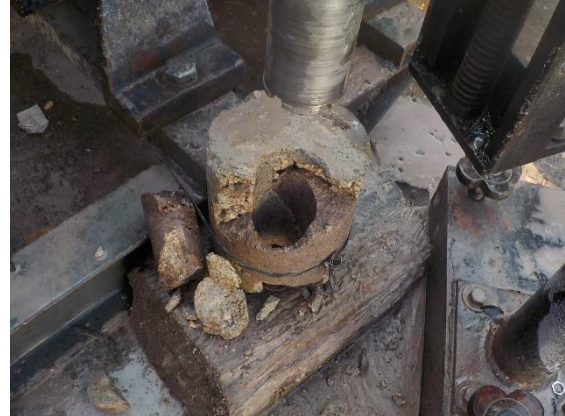
Fotografía III.39 Extracción de muestras del núcleo de la cortina para el ensaye a corte directo.
