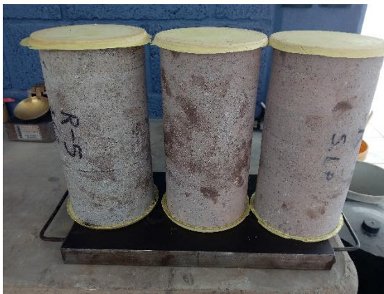
Fotografía III.34 Cabeceo de nucleos de roca de cimentación para ensaye a compresión uniaxial.
