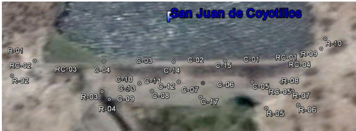
Figura III.9 Ubicación de los puntos donde se realizaron los sondeos.
