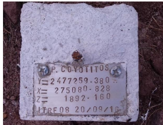
Fotografía III.3 Coordenadas del vértice de referencia GPS1 en la presa San Juan de Coyotillos.
