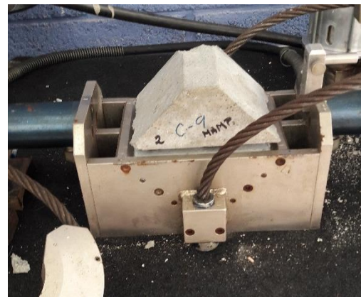
Fotografía III.43 Prueba de corte directo a una muestra de mampostería.
