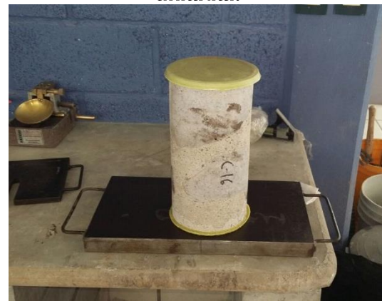
Fotografía III.35 Cabeceo de nucleo de la cortina para ensaye a compresión uniaxial.
