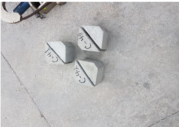
Fotografía III.42 Muestras coladas y listas para ensaye a corte directo.
