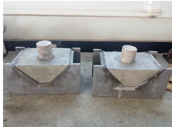
Fotografía III.41 Preparación de probetas para el ensaye a corte directo
