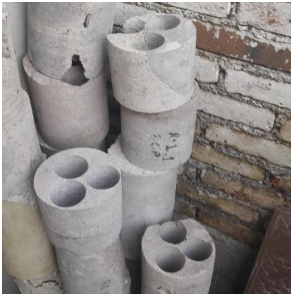
Fotografía III.40 Núcleos despues de haber extraido probetas para su ensaye a corte directo.
