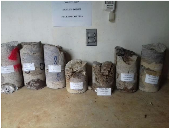
Fotografía III.32 Nucleos extraídos de la cortina para su ensaye en el laboratorio.
