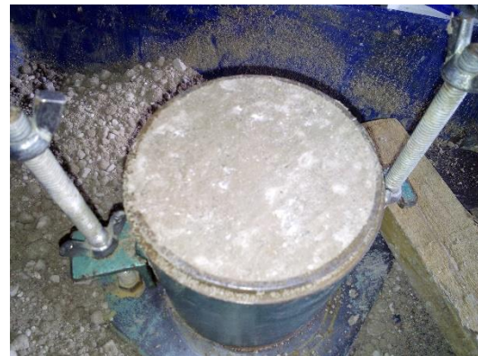
Fotografía III.37 Prueba de compactación Proctor estándar.
