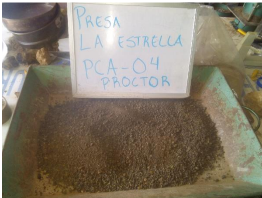
Fotografía III.36 Preparación del material para la prueba de compactación Proctor estándar.
