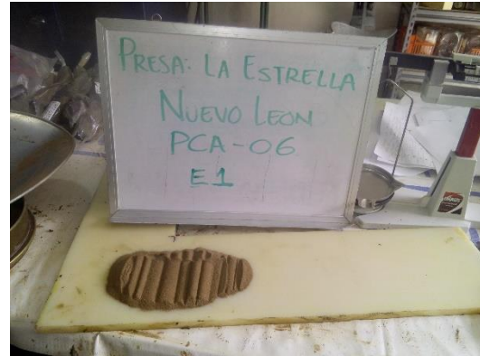
Fotografía III.33 Preparación del material para los límites de consistencia.
