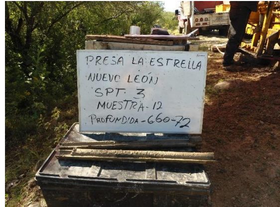
Fotografía III.31 Muestra de suelo recuperada del SPT-03.
