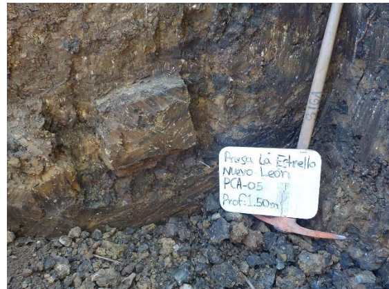
Fotografía III.23 Toma de muestra inalterada de suelo en el PCA-5.
