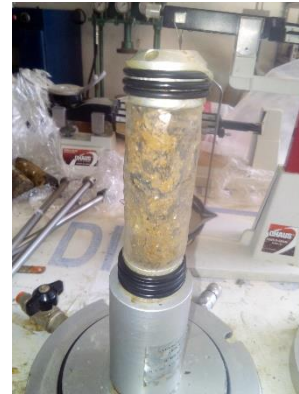
Fotografía III.39. Muestra antes de prueba de compresión triaxial.
