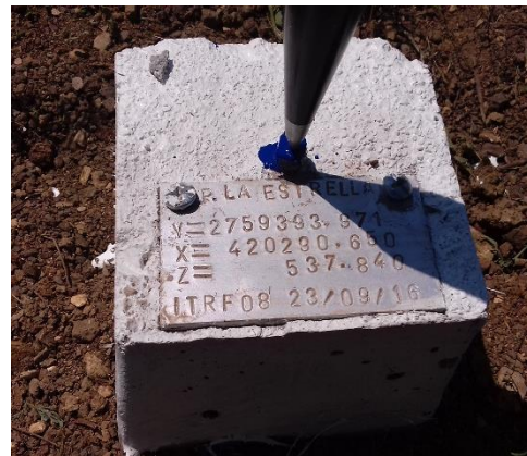
Fotografía III.3 Coordenadas del vértice de referencia GPS1 en la presa La Estrella.
