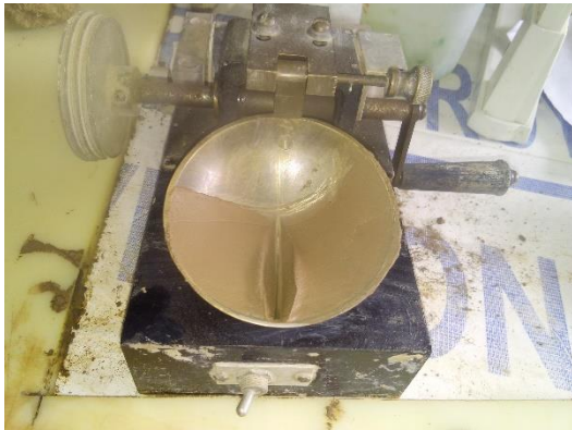
Fotografía III.34 Prueba de límite líquido en copa de Casagrande.
