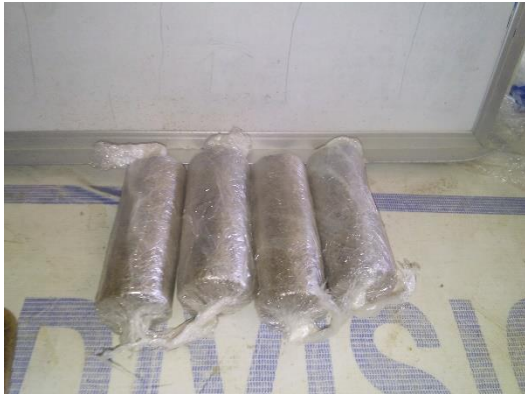
Fotografía III.38 Muestras labradas para la prueba de compresión triaxial.
