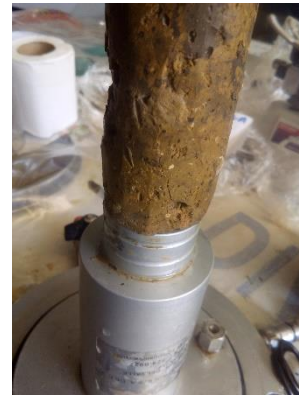
Fotografía III.41 Prueba después de la prueba de compresión triaxial.
