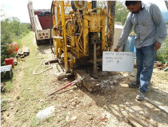
Fotografía III.30 Perforación del SPT-03 en el extremo derecho de la cortina.
