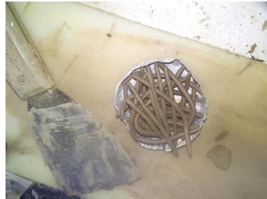
Fotografía III.35 Prueba de límite plástico con técnica de rolado.
