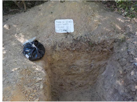
Fotografía III.19 Toma de muestra alterada de suelo en el PCA-3.
