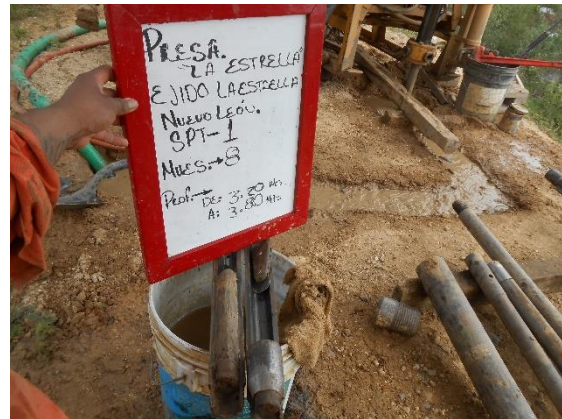
Fotografía III.27 Muestra de suelo recuperada del SPT-01.
