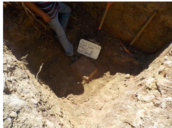
Fotografía III.15 Labrado de muestra cubica inalterada en el PCA-1.
