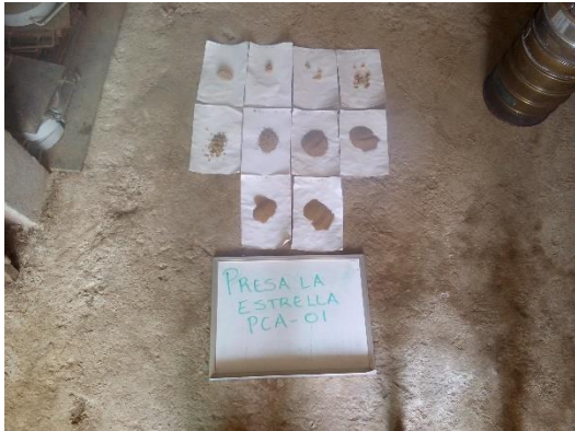
Fotografía III.32 Material del PCA-1 después de granulometría por mallas.
