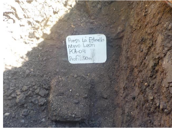
Fotografía III.21 Toma de muestra inalterada de suelo en el PCA-4.
