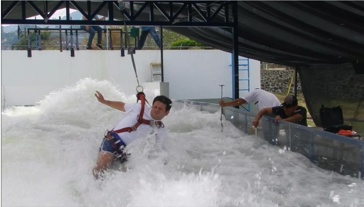
Figura V.34 prueba realizada por el peatón 13 donde se presentó su límite máximo de resistencias al vuelco, provocando su caída.
