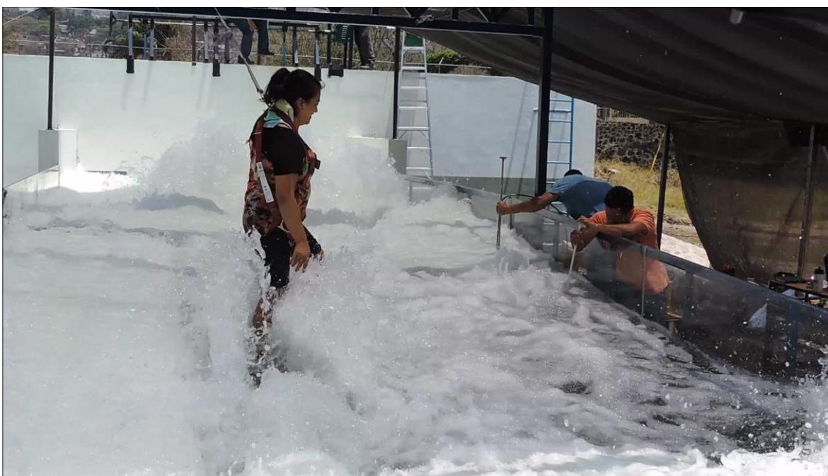
Figura V.15 prueba realizada por el peatón 4 donde se presentó su límite máximo de resistencias al vuelco.
