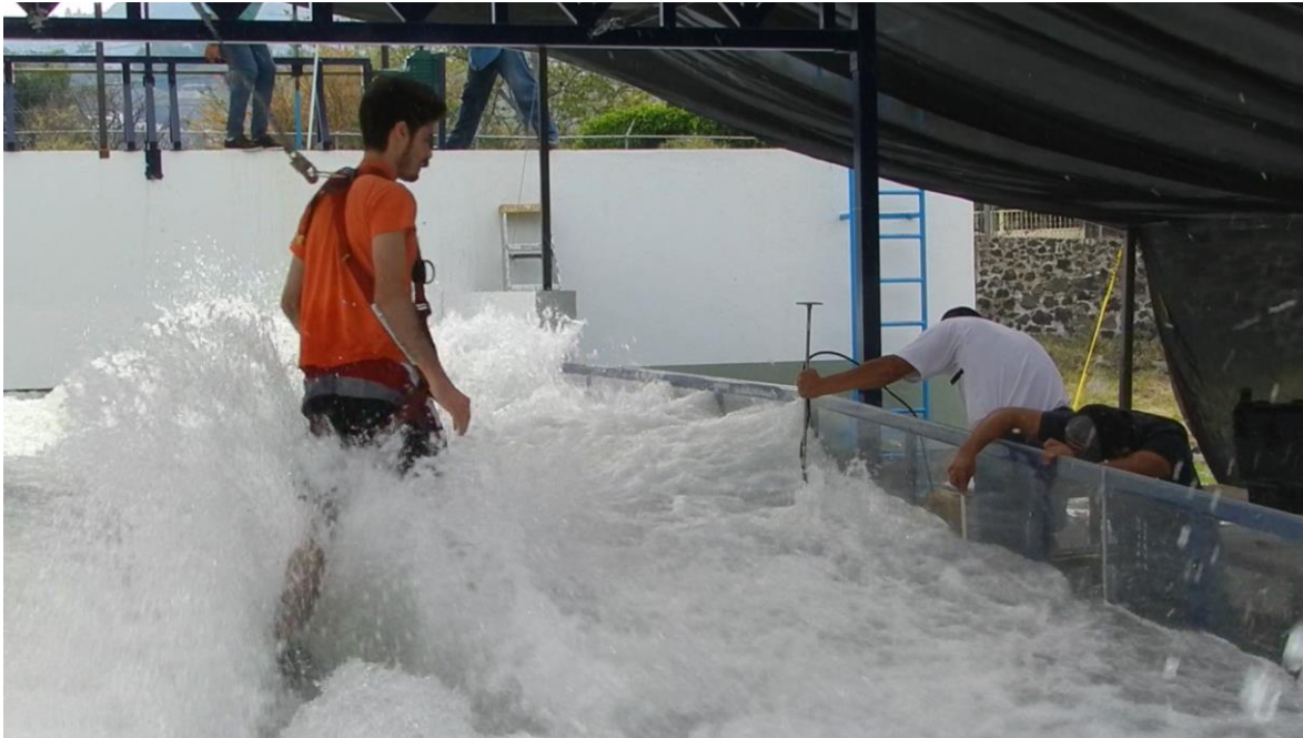
Figura V.13 prueba realizada por el peatón 3 donde se presentó su límite máximo de resistencias al vuelco.
