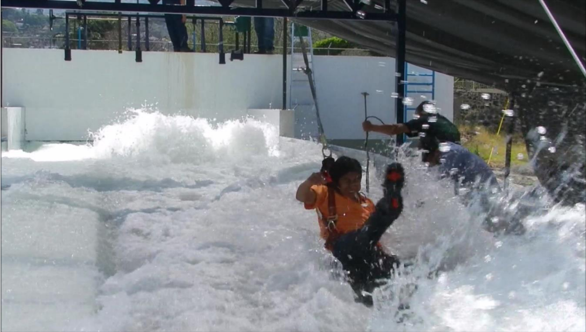
Figura V.24 prueba realizada por el peatón 8 donde se presentó su límite máximo de resistencias al vuelco, provocando su caída.
