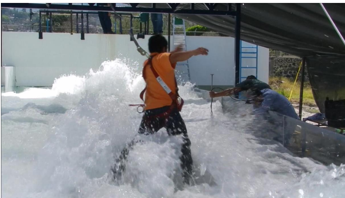
Figura V.23 prueba realizada por el peatón 8 donde se presentó su límite máximo de resistencias al vuelco.
