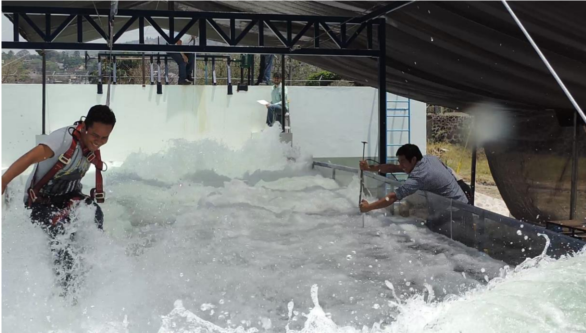
Figura V.20 prueba realizada por el peatón 6 donde se presentó su límite máximo de resistencias al vuelco, provocando su caída.
