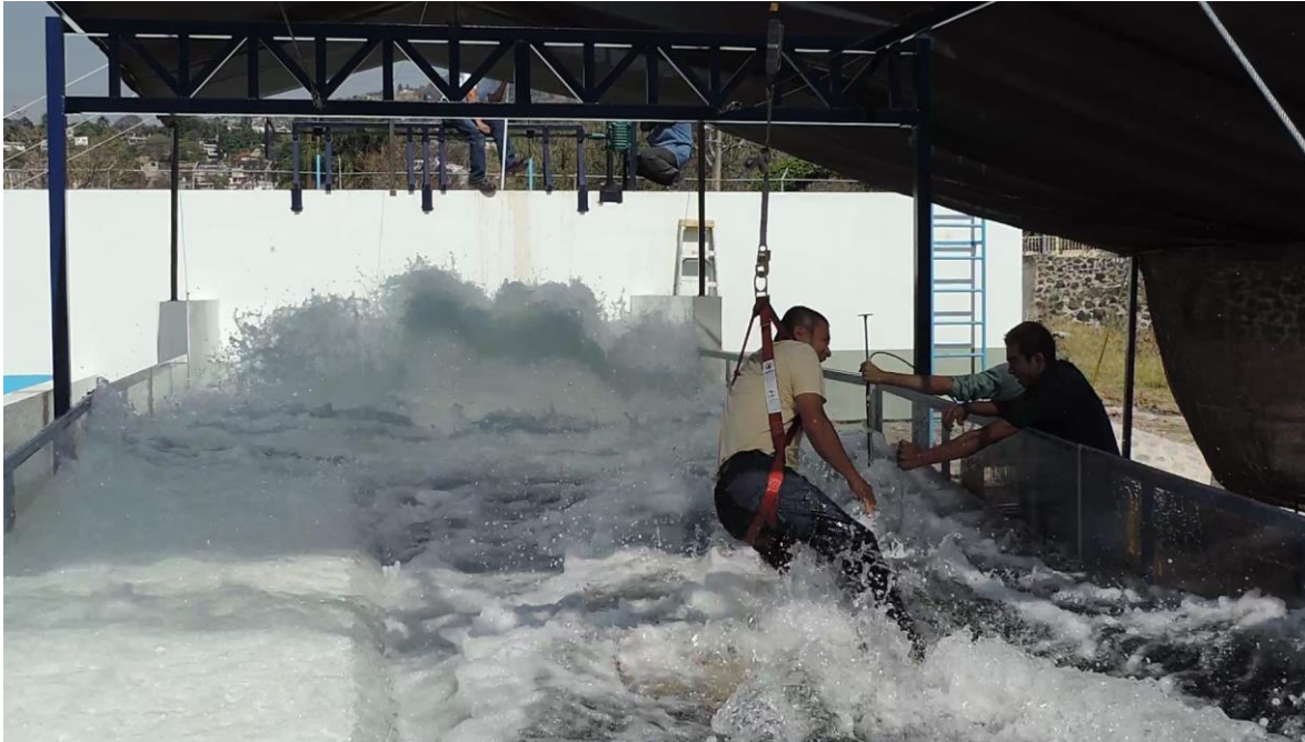
Figura V.12 prueba realizada por el peatón 2 donde se presentó su límite máximo de resistencias al vuelco, provocando su caída.
