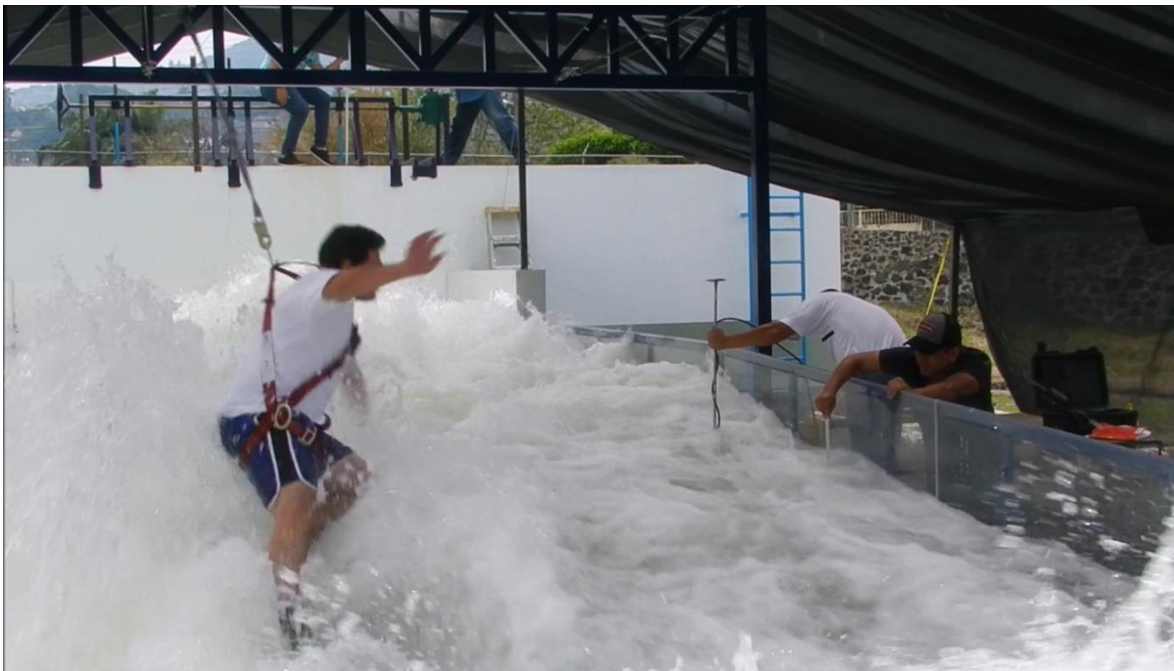
Figura V.33 prueba realizada por el peatón 13 donde se presentó su límite máximo de resistencias al vuelco.
