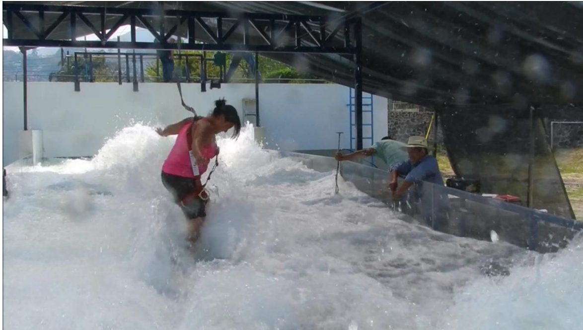
Figura V.31 prueba realizada por el peatón 12 donde se presentó su límite máximo de resistencias al vuelco.
