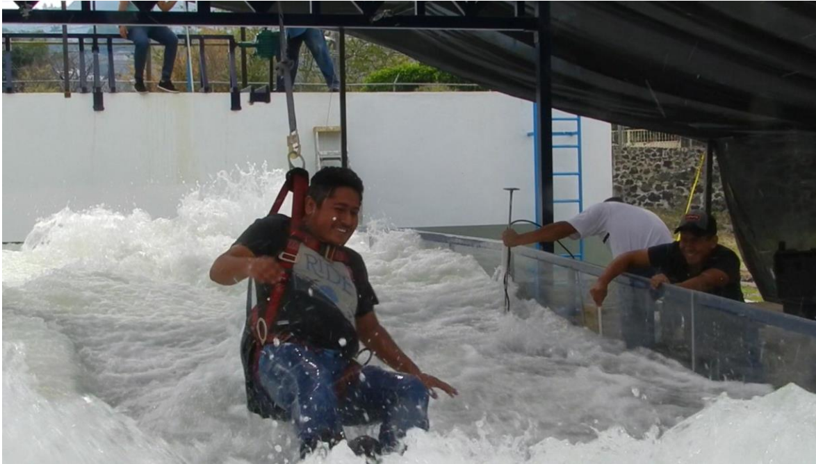
Figura V.28 prueba realizada por el peatón 10 donde se presentó su límite máximo de resistencias al vuelco, provocando su caída.
