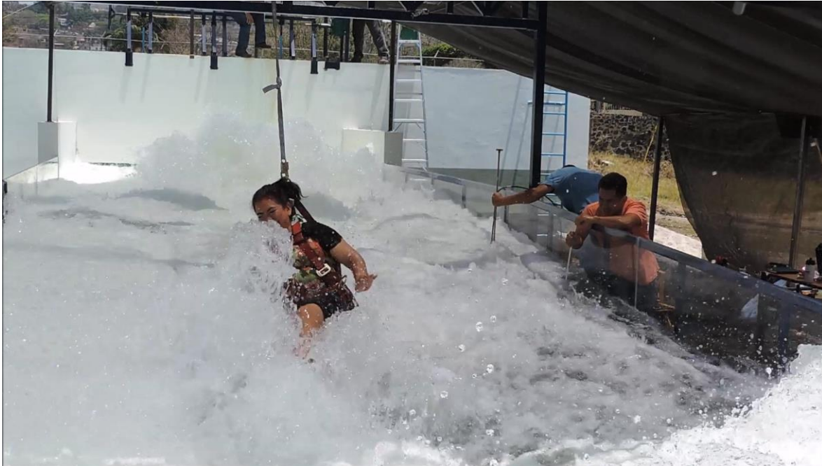
Figura V.16 prueba realizada por el peatón 4 donde se presentó su límite máximo de resistencias al vuelco, provocando su caída.
