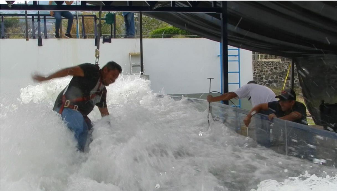
Figura V.27 prueba realizada por el peatón 10 donde se presentó su límite máximo de resistencias al vuelco.
