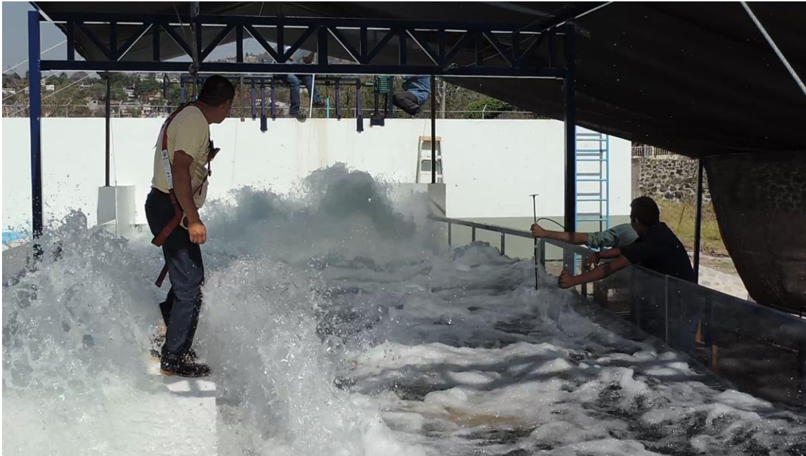
Figura V.11 prueba realizada por el peatón 2 donde se presentó su límite máximo de resistencias al vuelco.
