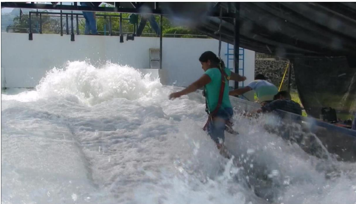
Figura V.17 prueba realizada por el peatón 5 donde se presentó su límite máximo de resistencias al vuelco.
