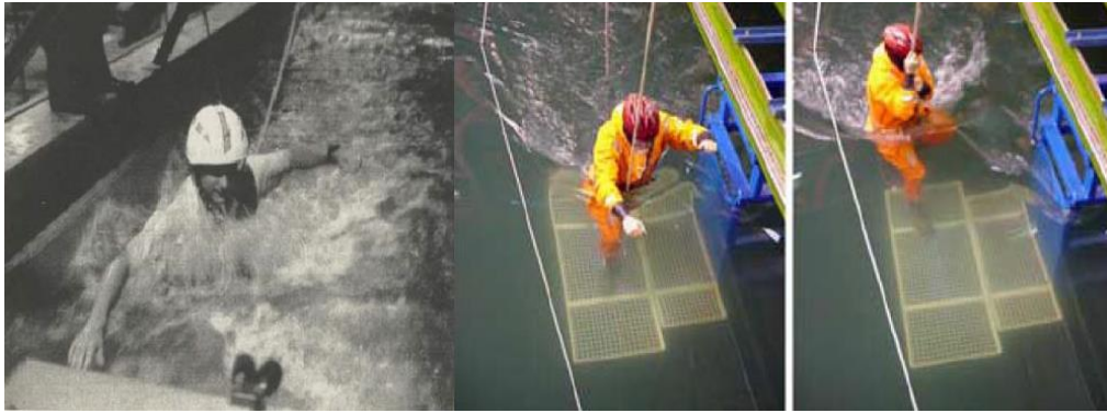
Figura I.2 Algunas experiencias experimentales sobre la estabilidad humana en canales (Abt et al., 1989; ARMC, 2000).
