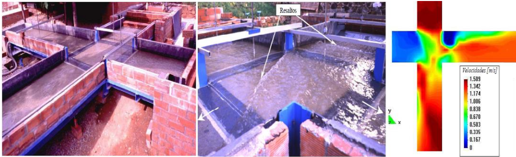
Figura 1.8 Modelos experimentales y numéricos (distribución de tirantes y velocidades).
