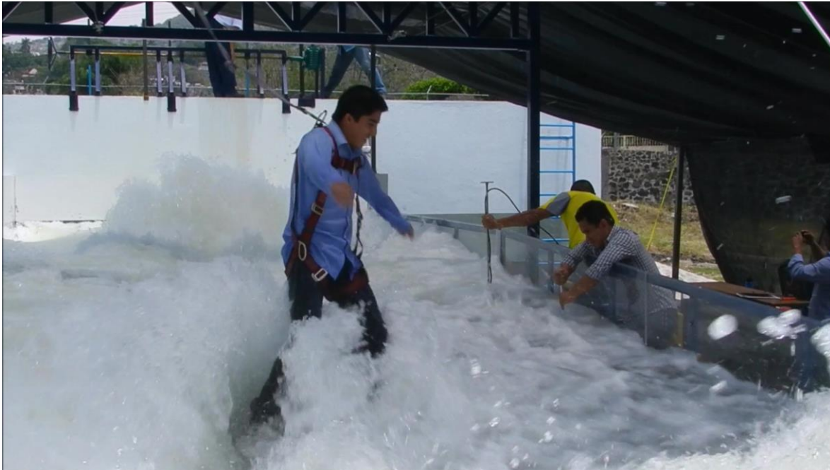
Figura V.29 prueba realizada por el peatón 11 donde se presentó su límite máximo de resistencias al vuelco.
