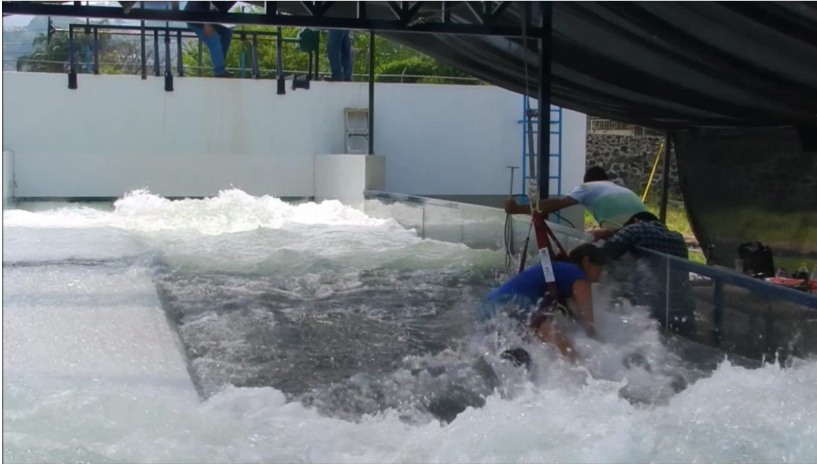
Figura V.36 prueba realizada por el peatón 14 donde se presentó su límite máximo de resistencias al vuelco, provocando su caída.
