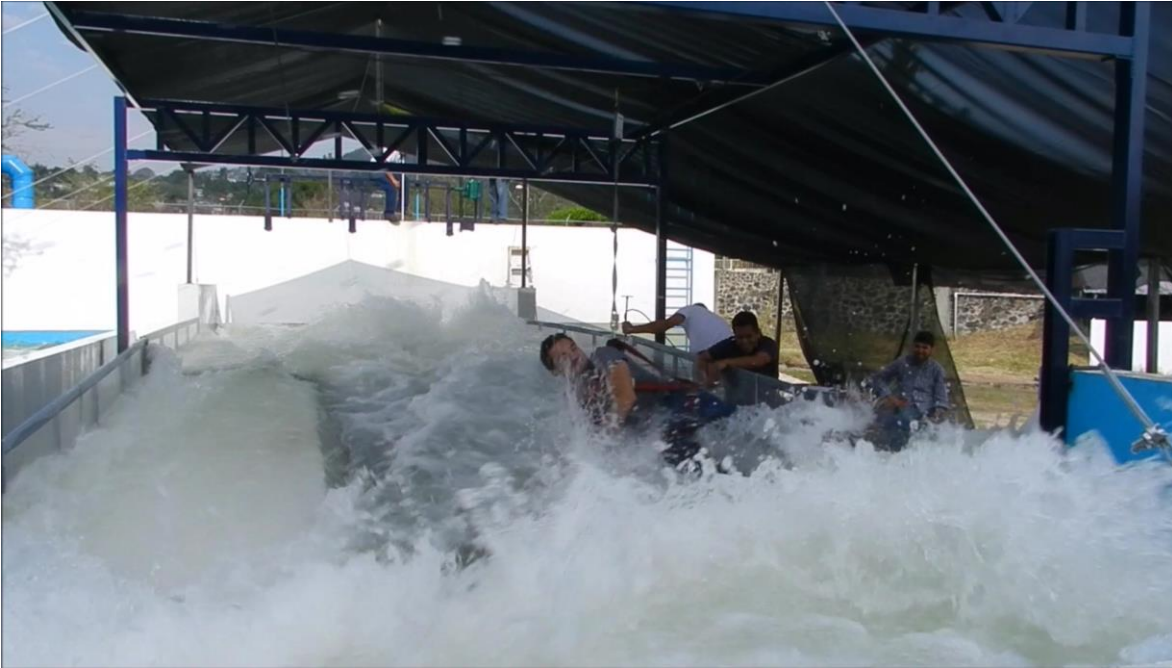
Figura V.26 prueba realizada por el peatón 9 donde se presentó su límite máximo de resistencias al vuelco, provocando su caída.
