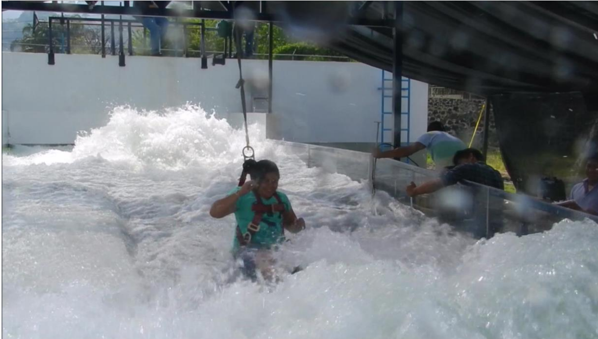
Figura V.18 prueba realizada por el peatón 5 donde se presentó su límite máximo de resistencias al vuelco, provocando su caída.
