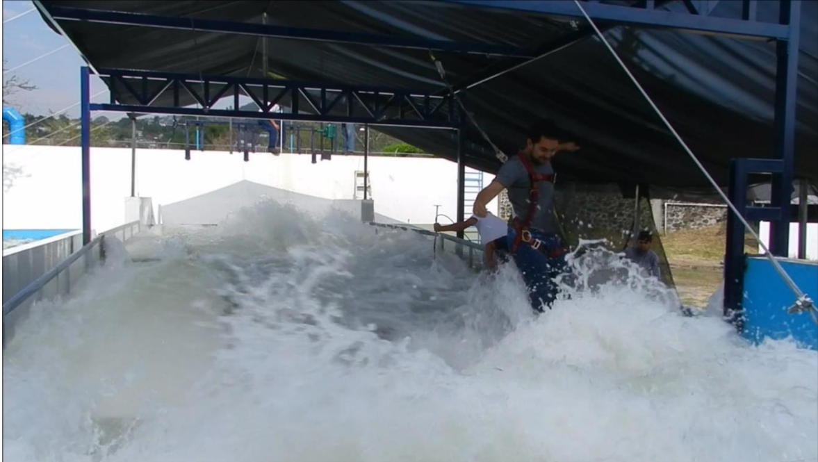
Figura V.25 prueba realizada por el peatón 9 donde se presentó su límite máximo de resistencias al vuelco.
