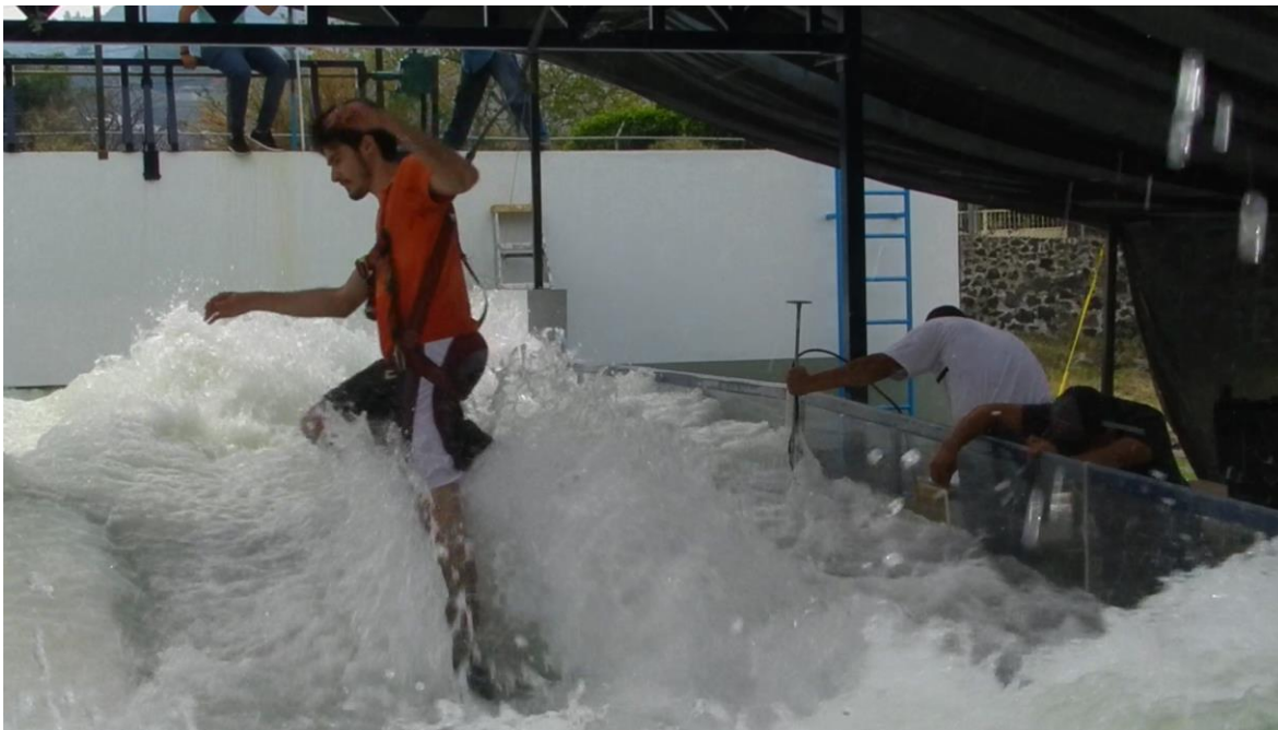
Figura V.14 prueba realizada por el peatón 3 donde se presentó su límite máximo de resistencias al vuelco, provocando su caída.
