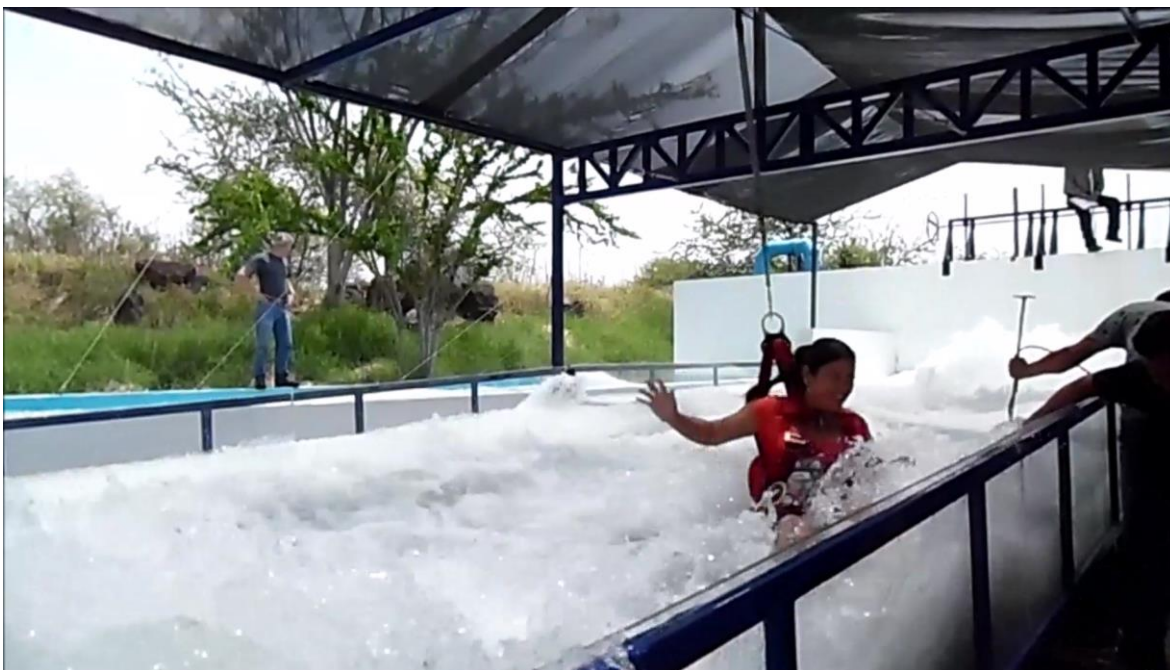
Figura V.22 prueba realizada por el peatón 7 donde se presentó su límite máximo de resistencias al vuelco, provocando su caída.
