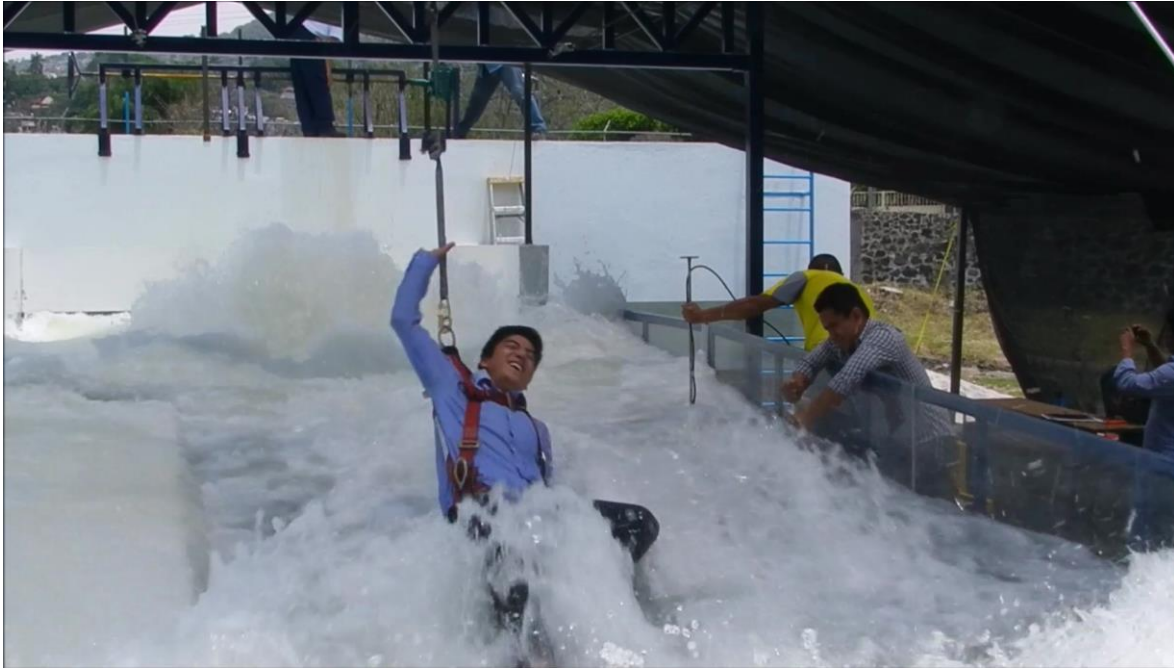
Figura V.30 prueba realizada por el peatón 11 donde se presentó su límite máximo de resistencias al vuelco, provocando su caída.
