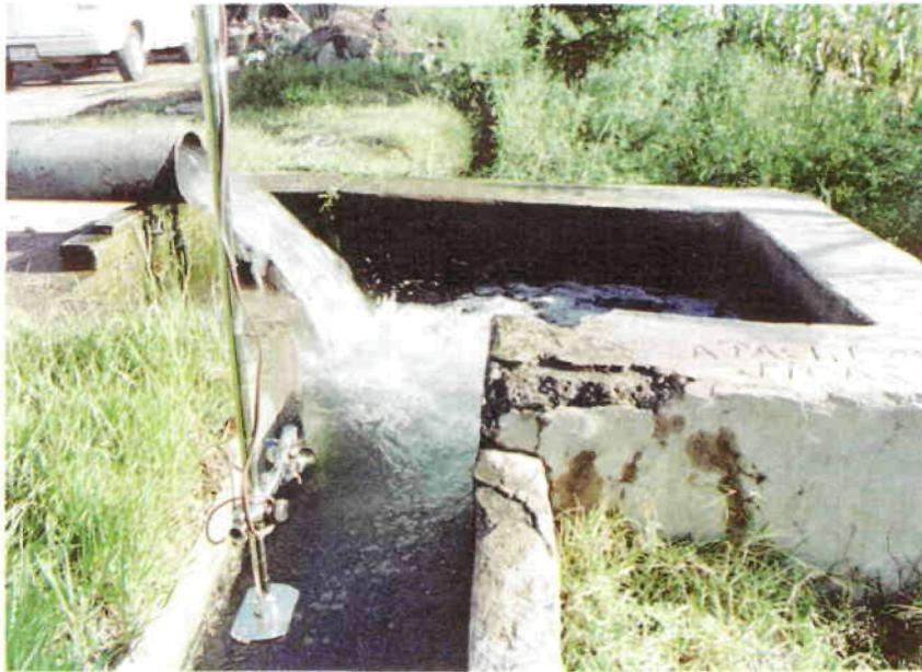
*Lámina 28 Pileta y canal de concreto para conducir el agua por gravedad; medición con molinete*
