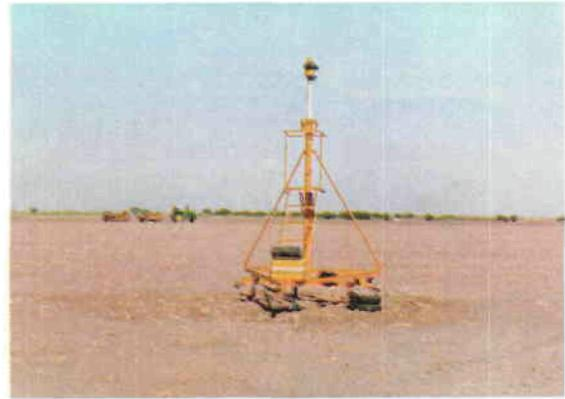
*Lamina 62 Equipo para nivelación con rayo laser colocado en el centro del terreno*
