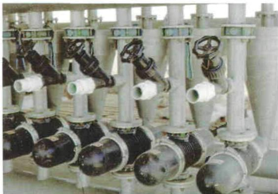
*Lámina 46 Sistema de filtrado con hidrociclones y filtros de mallas*
