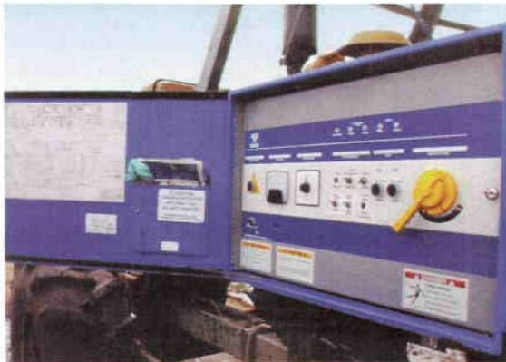
*a) Tablero de control de un pivote central que controla lámina aplicada en cada revolución*
