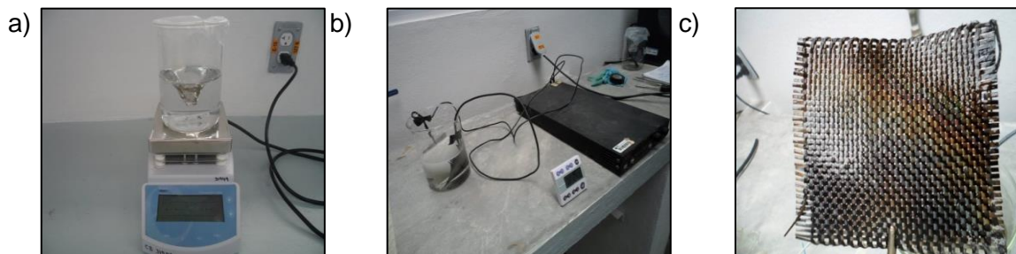
Figura 3.5. a) Preparación de la solución Electrolítica, b) Técnica de Electrodeposición con PbO_2 , c) Tela de grafito después de la técnica de electrodeposición con PbO_2 .
