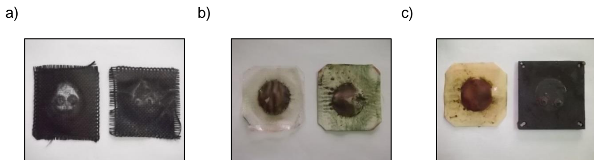
Figura 4.1. a) Membrana iónica y catiónica después del periodo de alimentación continua de la CCM1 y CCM2, b). Telas de grafito después del periodo en alimentación continua en la CCM1 y CCM2, c) Membrana aniónica y placa de carbón después del periodo en alimentación continua en la CCM3 y CCM5.
