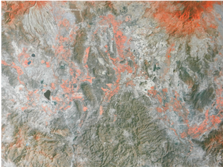
Imagen de satélite 2. Imagen de satélite Landsat TM 4- INEGI. Bandas 4, 3, 2. En donde se muestra en Color rojo los cuerpos clorofilados (vegetación), en color negro los cuerpos de agua superficial. Y en color azul oscuro los cuerpos de agua superficiales con poco espesor de agua.
