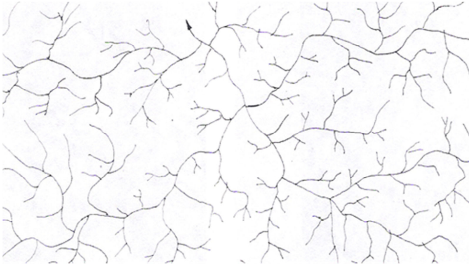
Figura 3. Patrón de drenaje dendrítico, el cual se desarrolla en los paquetes de rocas arcillosas.
