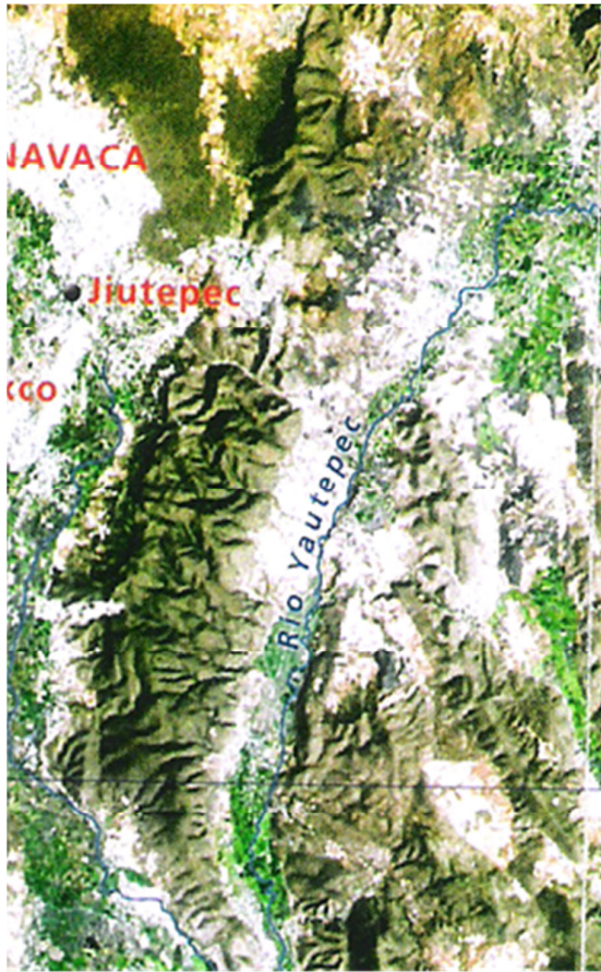
Imagen de satélite 3. Imagen multiespectral, en las combinaciones de las bandas 7-3-2. La banda 7 corresponde al infrarrojo intermedio y, las bandas 3 y 2, corresponden al espectro visible.
