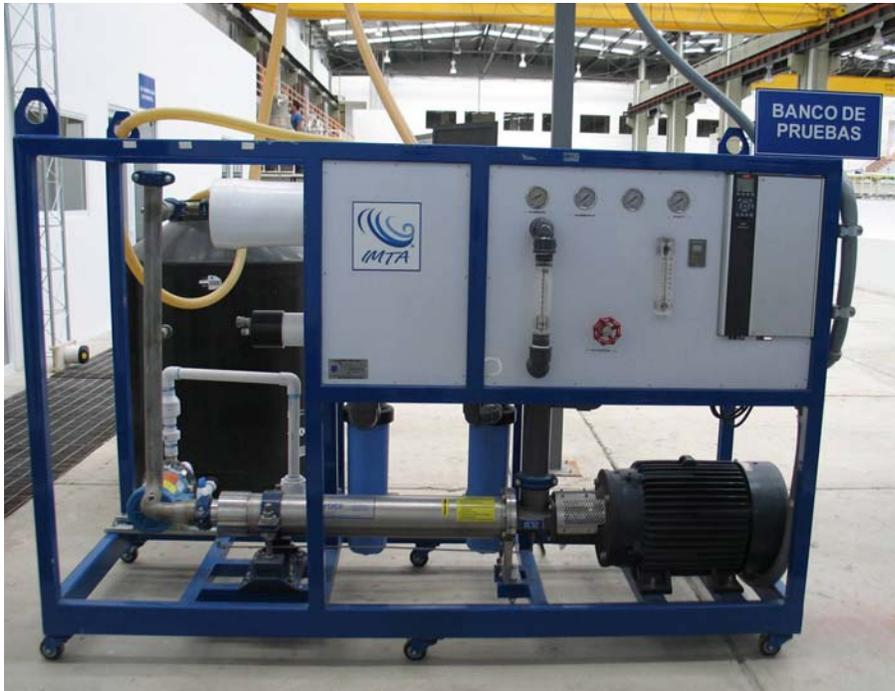
Fig. 25. Banco de pruebas utilizado para probar a las distintas membranas.
