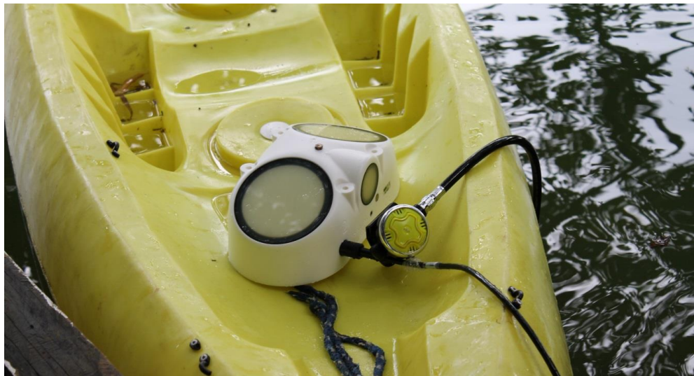
Fig. 10. Perfilador Doppler de 500 kHz anclado en Subteniente López, Chetumal, Q.R.
