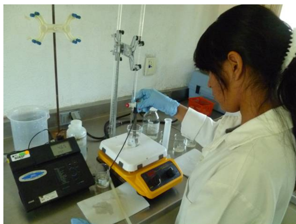
Foto 5.23 Determinación de dureza
