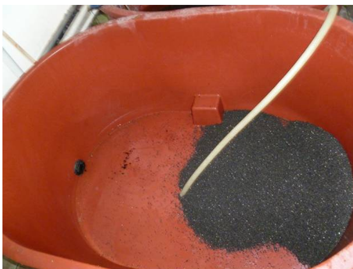
Foto 5.9 Lavado de material filtrante
