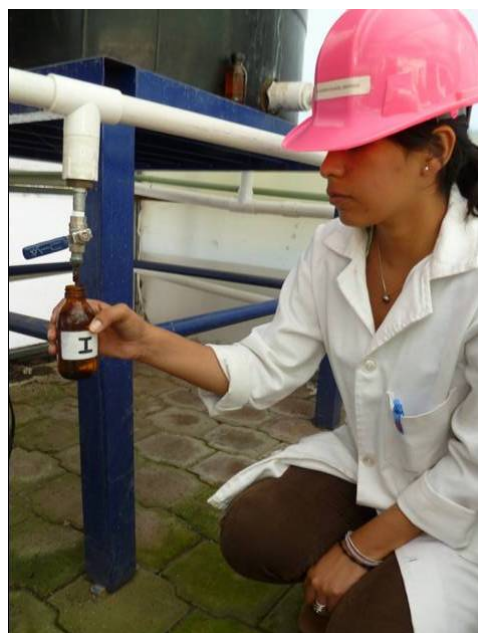
Foto 5.16 Toma de muestra entrada del filtro
