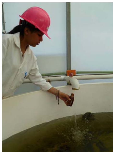
Foto 5.17 Toma de muestra salida del filtro
