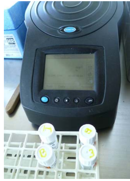
Foto 5.26 Determinación de nitrógeno total
