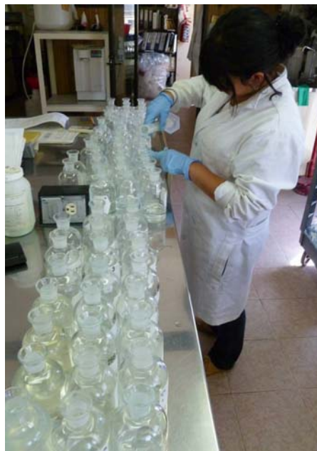
Foto 5.28 Determinación de DBO
