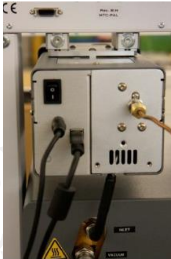
Figura 1.15 Conexión del vaporizador de alto rendimiento.
