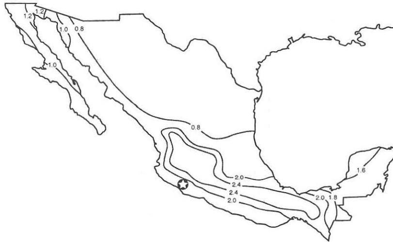
Figura 3.11 Contornos de pseudoaceleración estructural normalizada con la aceleración máxima del terreno para un periodo de vibración de 0.3 segundos.
