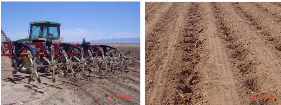
Figura 6.18 Pileteadora para la reducción de escurrimientos superficiales
