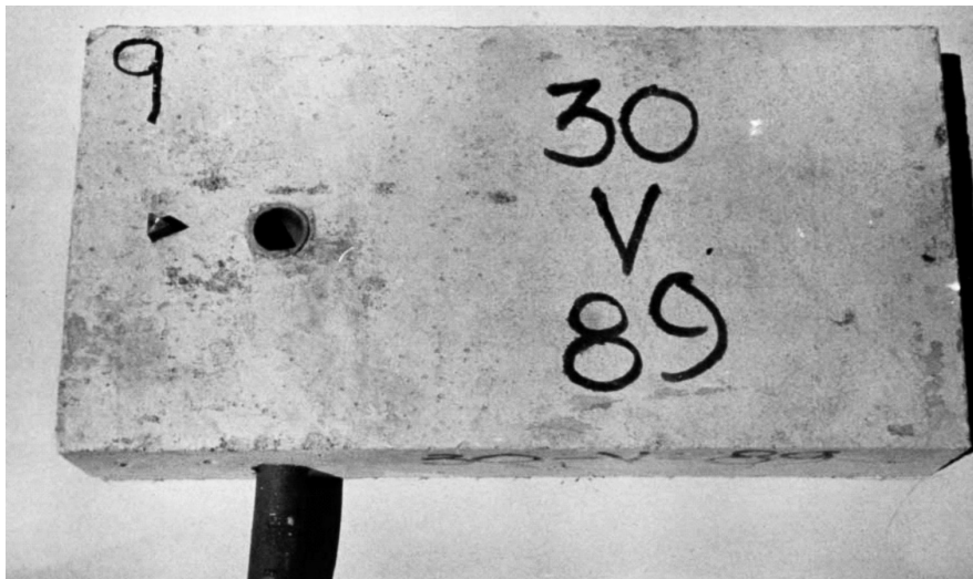
Figura 59. Probeta con aereador, en cuya toma se colocó un tubo unido a un anemómetro.
