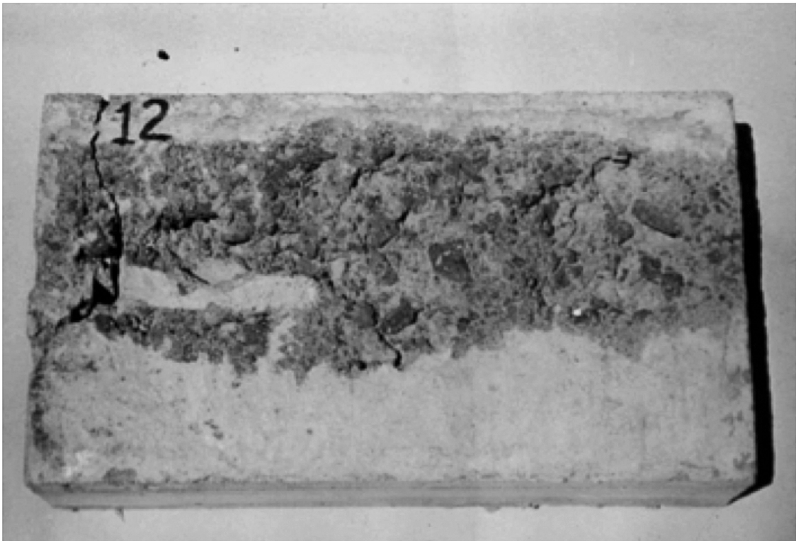
Figura 55. Probeta experimental de concreto, colocada en el canal de alta velocidad, del Instituto de Ingeniería de la Universidad Nacional Autónoma de México.
