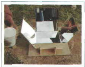
Figura 6. Caja solar terminada.
